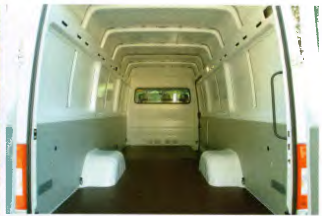
Sprinter furgão com teto alto tem capacidade para 13,4 m 3 ou 2.270 kg de carga
