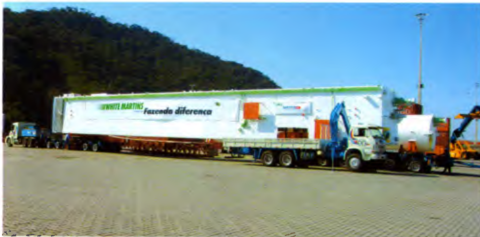
Conjunto transportador com 6 linhas de eixo para levar o cold-box até o porto
