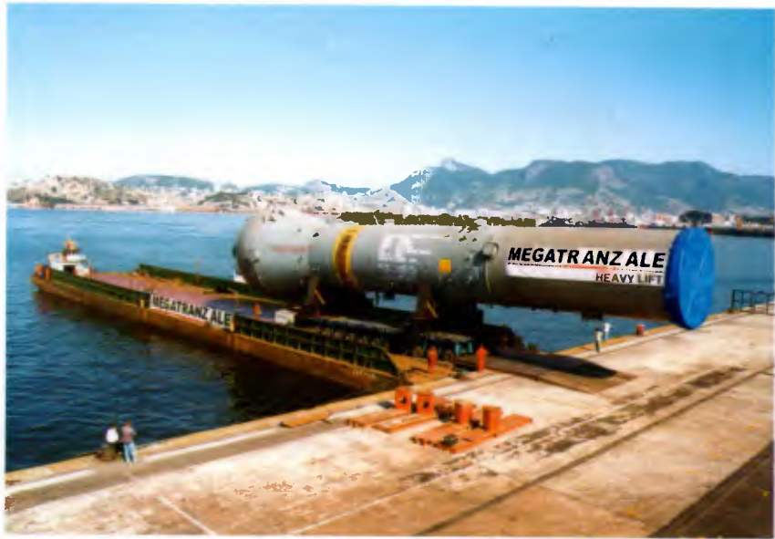
Reator sendo colocado na barcaça em operação demorou 1,5 hora
