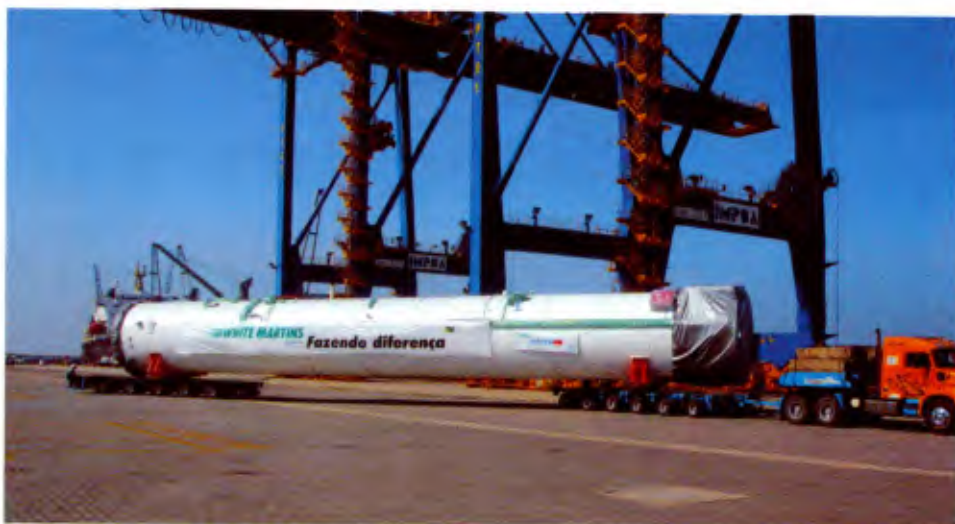
Cada seção do cold-box pesa 100 t e tem mais de 30 m de comprimento
