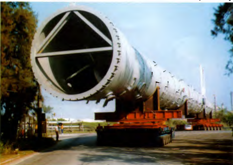
Peça transportada por carreta Hyspec autopropelida capaz de manobras de 360 graus
