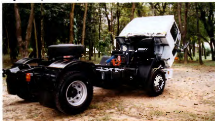
Distância entre-eixos de 3.560 mm adequada para semi-reboques de 30 paletes
