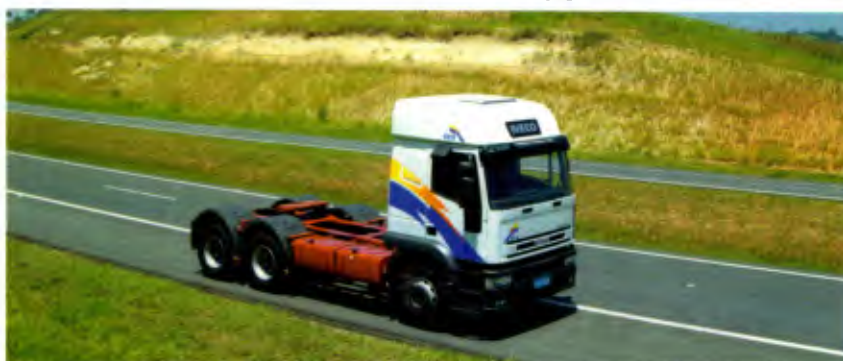
EuroTech 740: cavalo-mecânico preparado para tracionar composição bitrem
