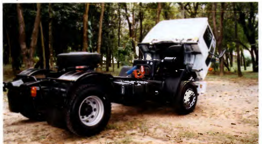
Distância entre-eixos de 3.560 mm adequada para semi-reboques de 30 paletes
