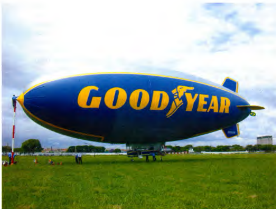
O Ventura tem velocidade de cruzeiro de 74 km/hora e atinge 3.000 m de altitude
