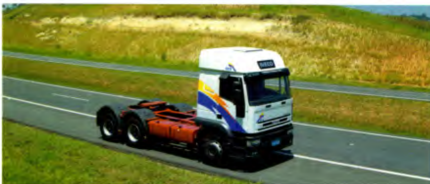
EuroTech 740: cavalo-mecânico preparado para tracionar composição bitrem
