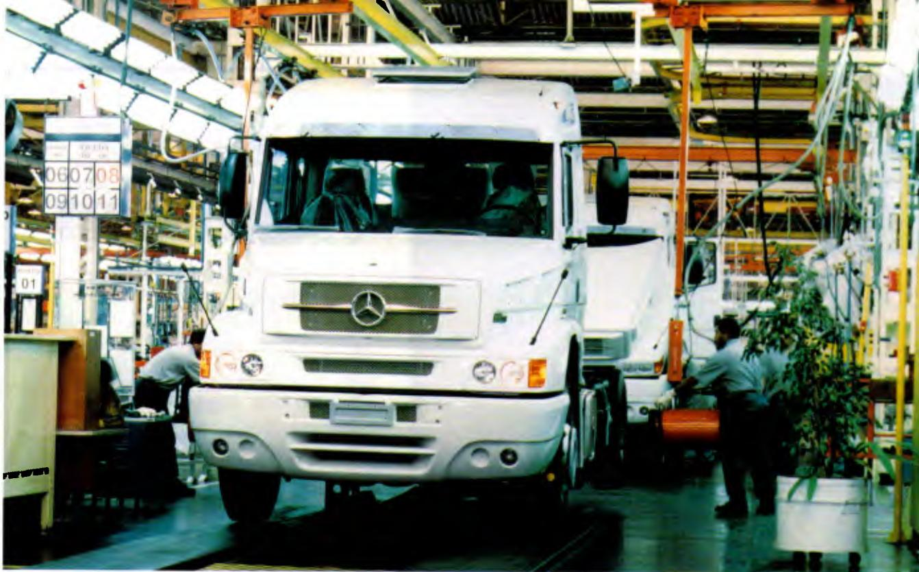
O novo LS-1938 possui motorização eletrônica, freios a disco nas quatro rodas e altura do teto de 1,90 m
