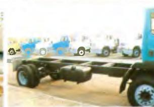
**Motor com taxa de compressão maior (18:1); cabine com novo acabamento; inovação no sistema de freios, longarinas retas permitem carrocerias com até 7,25 m de comprimento**
