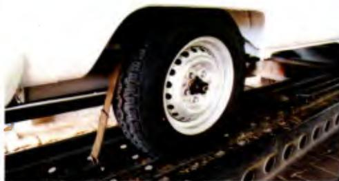
**A cegonha Nova Era usa norma aeronáutica em plataformas. As transportadoras substituem cintas de amarração por cintas de nylon para evitar avarias.**
