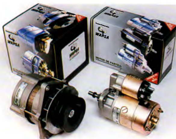
Alternador e motor de partida da Wapsa compõem o Sistema de Troca
