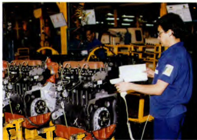
O leitor a laser lê o código de barras e decodifica-o
