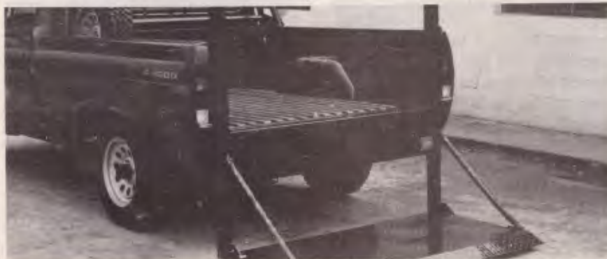
O equipamento pode ser acionado por um conjunto de cilindro hidráulico
