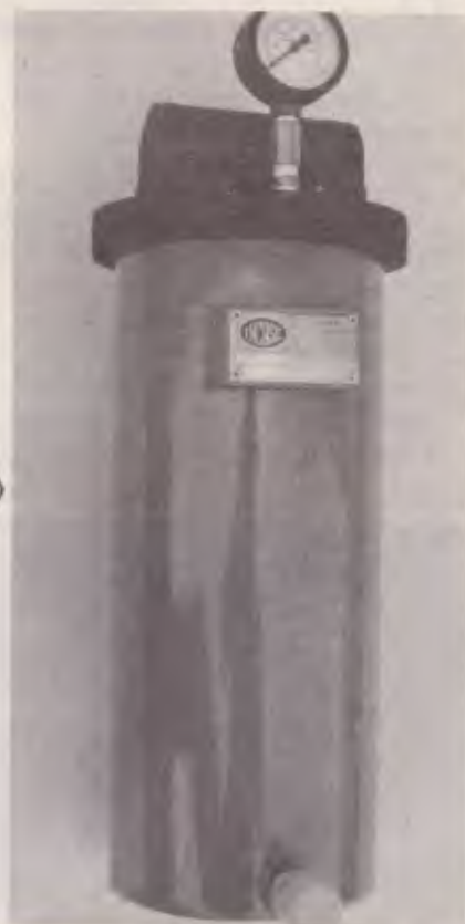
Filtrojet dá vazão de 9 m 3 /h de óleo
