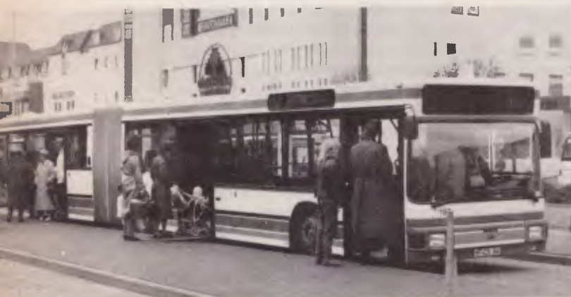
Nivelamento dos biarticulados se dá com rebaixamento dos veículos
