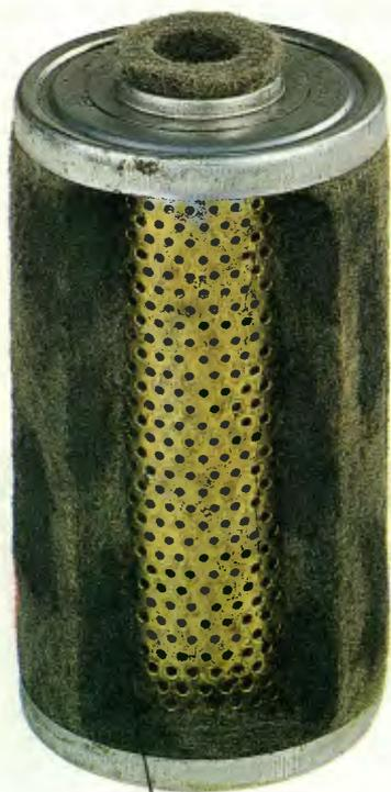
MICROIMPUREZAS QUE IRIAM PARA A BOMBA E OS BICOS INJETORES DANIFICANDO TODO O SISTEMA DE INJEÇÃO.
