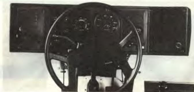
Suspensão inteiramente a ar, volante ajustável em altura e inclinação, painel equipado com grande conta-giros, chassi soldado e travessas quadradas são algumas características da plataforma B-10M
