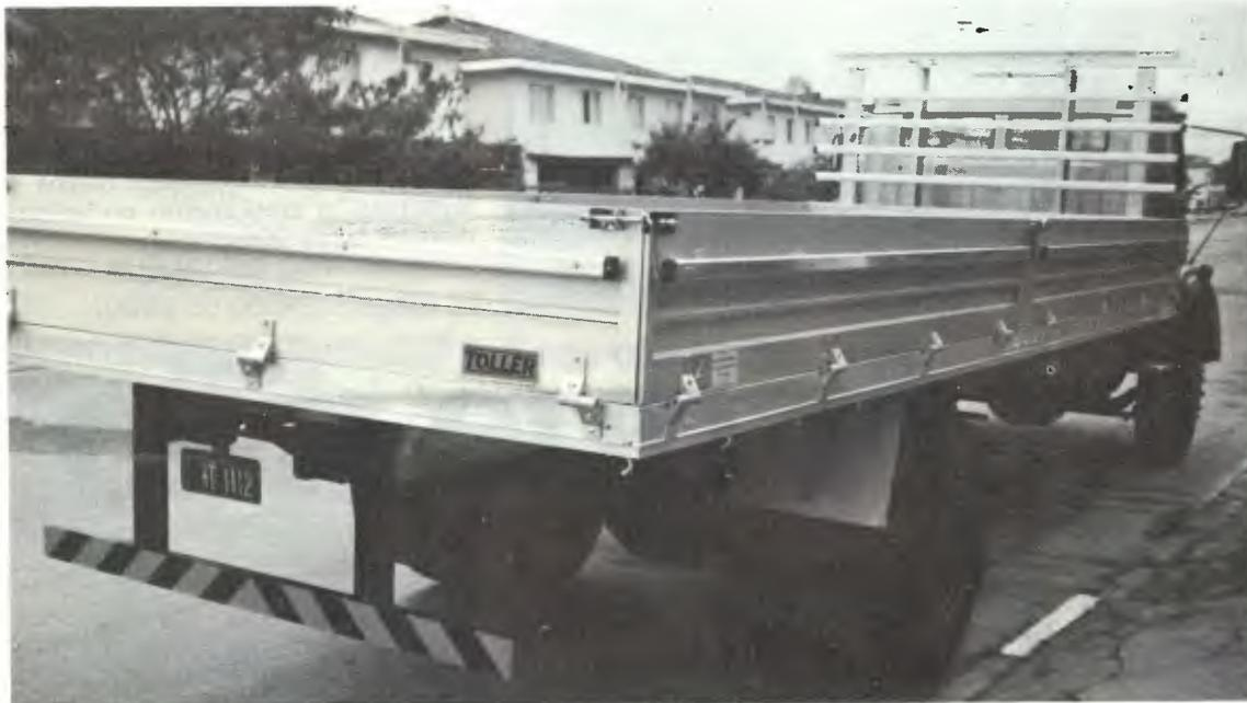
**Dispensando estrutura e aço, os novos furgões de alumínio permitem ganho substancial de espaço interno. As seções facilitam a manutenção e a construção modular simplifica a manutenção**
