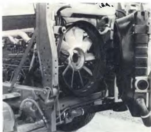
Radiador basculante: facilidade de manutenção e acesso ao motor
