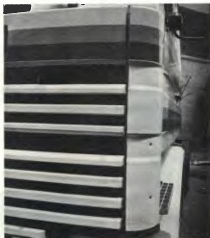
Os cantos facilitam o fluxo do ar
