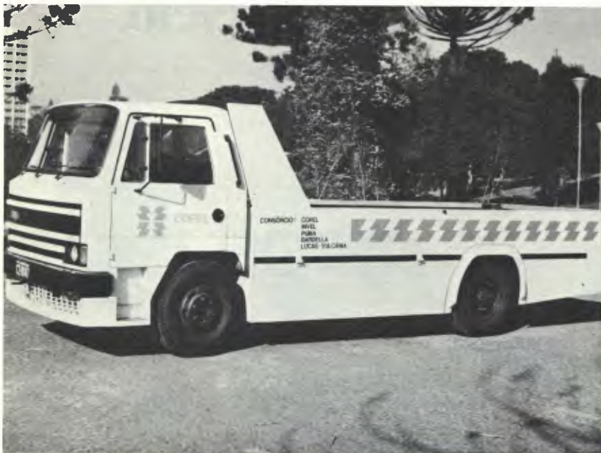
A transmissão do Eletron é como no trolebus, progressiva: não há câmbio
