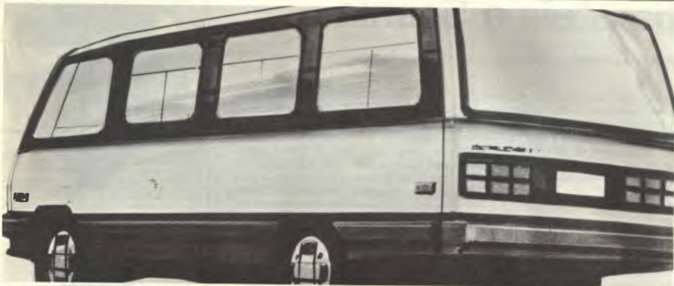
Um F-4000, repensado para microônibus, com duas opções: 32 ou 34 lugares
