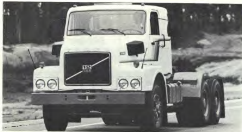
N-12: diferente do N-10 só no motor, mais potente e equipado com ventilador do radiador.
