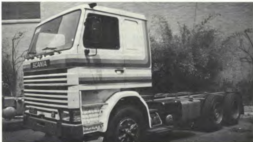
Linha R: o pára-brisas inclinado 20°, uma das formas de economizar combustível
