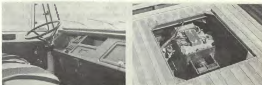
Eletron: 36 baterias, que pesam 1 030 kg, para alimentar um motor de 30 kw
