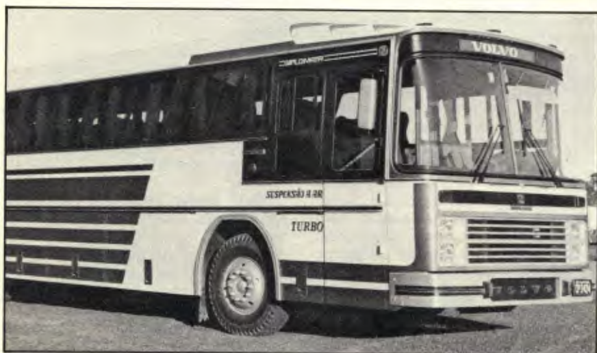
O ônibus B-58 da Volvo é projetado para suportar 6,5 t na dianteira
