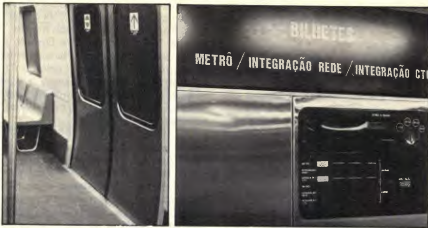
A porta, com 1,90m de vão, e o painel, ainda desligado
