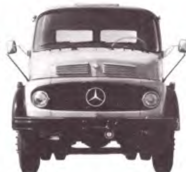
LK-1316 - Chassi de caminhão médio-pesado, com tomada de força. Peso bruto total: 12500kg. Distância entre eixos: 3600mm.
