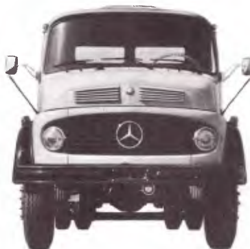
L-1516 - Chassi de caminhão médio-pesado. Peso bruto total: 15000kg. Distâncias entre eixos: 4200mm; 4830mm; 5170mm.
