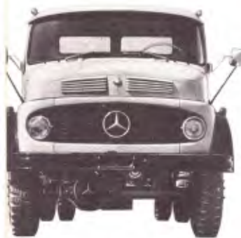
LAK-1113 4 x 4 - Chassi de caminhão médio, com tração total e tomada de força. Peso bruto total: 11000kg. Distância entre eixos: 3600mm.
