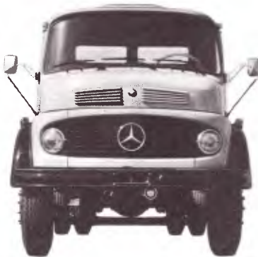
LK-1513 - Chassi de caminhão médio-pesado, com tomada de força. Peso bruto total: 15000kg. Distância entre eixos: 4200mm.
