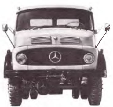
LA-1113 4 x 4 - Chassi de caminhão médio, com tração total. Peso bruto total: 11000kg. Distâncias entre eixos: 4200mm; 4830mm.
