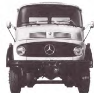
LK-2213 6 x 4 - Chassi de caminhão médio-pesado, com tomada de força, dotado de dois eixos traseiros em tandem, ambos motrizes. Peso bruto total: 22000kg. Distância entre eixos: 3600mm + 1300mm.
