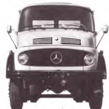
LB-2216 6 x 4 - Chassi de caminhão médio-pesado para betoneiras, com tomada de força na polia antivibradora do motor, dotado de dois eixos traseiros em tandem, ambos motrizes. Peso bruto total: 22000kg. Distância entre eixos: 3600mm + 1300mm.
