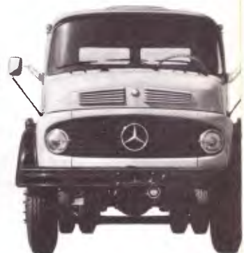
LK-1516 - Chassi de caminhão médio-pesado, com tomada de força. Peso bruto total: 15000kg. Distância entre eixos: 4200mm.
