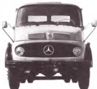
LS-1316 - Chassi de caminhão-tractor médio-pesado. Capacidade máxima de tração: 25000kg. Distância entre eixos: 3600mm.
