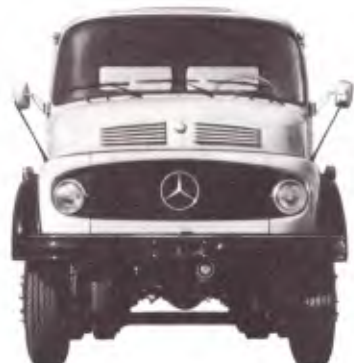
L-2213 6 x 4 - Chassi de caminhão médio-pesado, com dois eixos traseiros em tandem, ambos motrizes. Peso bruto total: 22000kg. Distâncias entre eixos: 3600mm + 1300mm; 4200mm + 1300mm.
