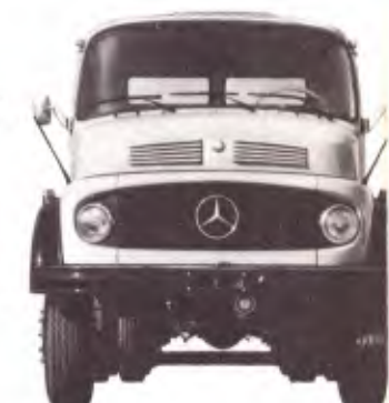
LB-2213 6 x 4 - Chassi de caminhão médio-pesado para betoneiras, com tomada de força na polia antivibradora do motor, dotado de dois eixos traseiros em tandem, ambos motrizes. Peso bruto total: 22000kg. Distância entre eixos: 3600mm + 1300mm.
