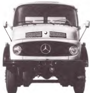
L-2216 6 x 4 - Chassi de caminhão médio-pesado, com dois eixos traseiros em tandem, ambos motrizes. Peso bruto total: 22000kg. Distâncias entre eixos: 3600mm + 1300mm; 4200mm + 1300mm.
