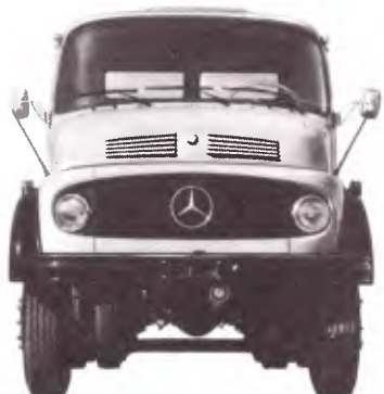
LK-2216 6 x 4 - Chassi de caminhão médio-pesado, com tomada de força, dotado de dois eixos traseiros em tandem, ambos motrizes. Peso bruto total: 22000kg. Distância entre eixos: 3600mm + 1300mm.
