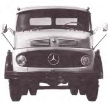
LK-1113 - Chassi de caminhão médio, com tomada de força. Peso bruto total: 11000kg. Distância entre eixos: 3600mm.
