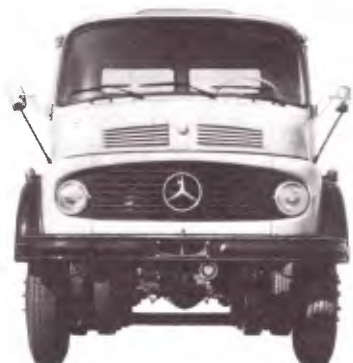
L-2013 6 x 2 - Chassi de caminhão médio-pesado, com dois eixos traseiros em tandem, o primeiro deles motriz. Peso bruto total: 21000kg. Distâncias entre eixos: 3600mm + 1300mm; 4200mm + 1300mm; 4823mm + 1300mm.
