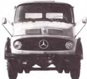
LK-1313 - Chassi de caminhão médio-pesado, com tomada de força. Peso bruto total: 12500kg. Distância entre eixos: 3600mm.
