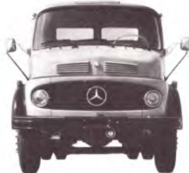
L-1313 - Chassi de caminhão médio-pesado. Peso bruto total: 13000kg. Distâncias entre eixos: 3600mm; 4200mm; 4830mm.
