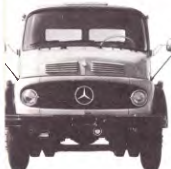
LS-1313 - Chassi de caminhão-tractor médio-pesado. Capacidade máxima de tração: 22500kg. Distância entre eixos: 3600mm.
