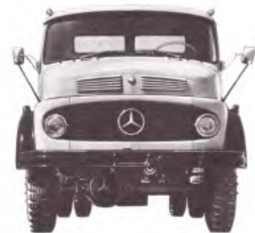
LAS-1113 4 x 4 - Chassi de caminhão-tractor médio, com tração total. Capacidade máxima de tração: 19000kg. Distância entre eixos: 3600mm.
