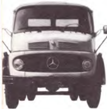
L-1113 - Chassi de caminhão médio. Peso bruto total: 11000kg. Distâncias entre eixos: 4200mm; 4830mm.
