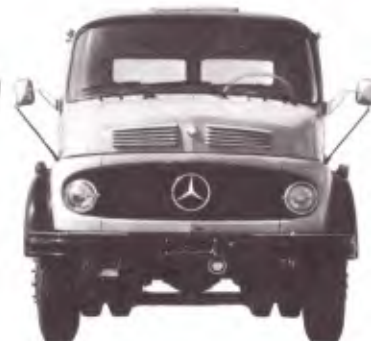
L-1316 - Chassi de caminhão médio-pesado, com tomada de força. Peso bruto total: 13000kg. Distâncias entre eixos: 3600mm; 4200mm; 4830mm.
