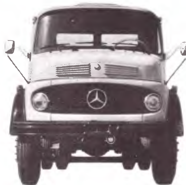
L-1513 - Chassi de caminhão médio-pesado. Peso bruto total: 15000kg. Distâncias entre eixos: 4200mm; 4830mm; 5170mm.
