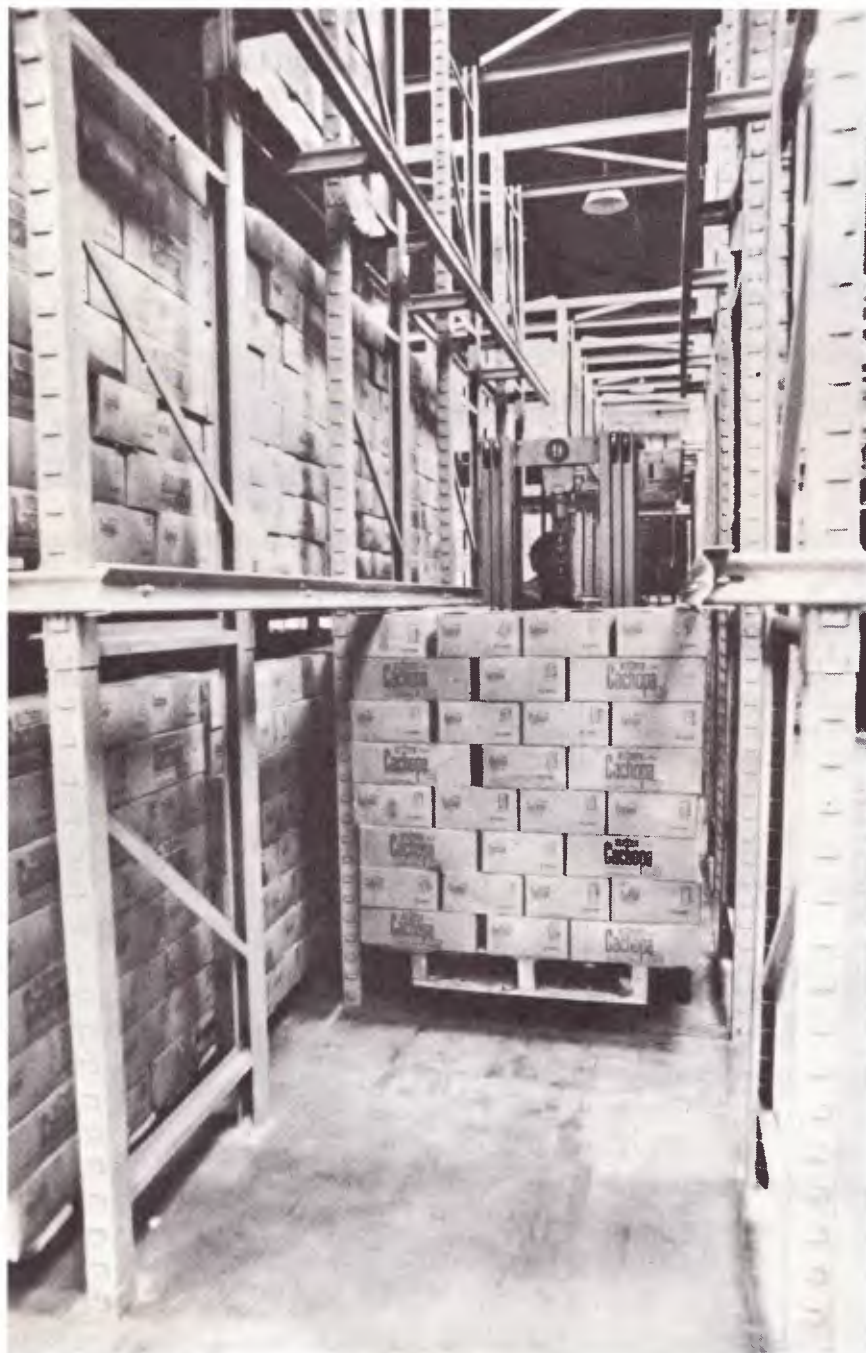
Entre as estruturas (custo de Cr$ 3 milhões), corredores de 1,5 m.
