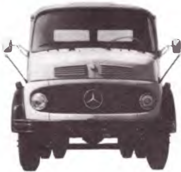
LS-1113 - Chassi de caminhão-tractor médio. Capacidade máxima de tração: 19000kg. Distância entre eixos: 3600mm.
