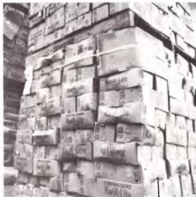
A esquerda, o sistema antigo: empilhadeira a gás ocupando corredor de 5 m e pallet sobre pallet, esmagando embalagens. A direita, o atual: empilhadeira elétrica, em corredor de 3 m, colocando pallet na estrutura ou apenas, de leve, na ombreira.
