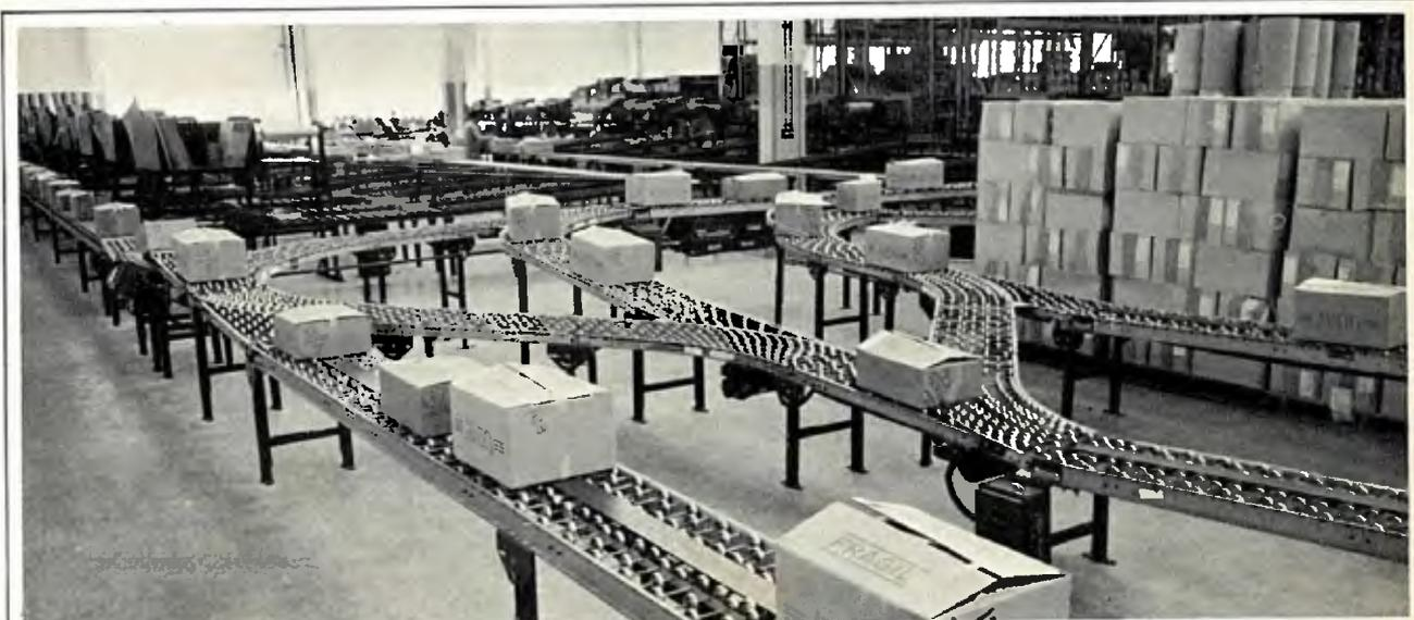
O transportador com roldana tem capacidade mínima de 7 kg/ml e máxima de 70 kg/ml. Vem equipado com motor de 1/2, 3/4 ou 1 hp, permitindo à esteira atingir velocidade de 0,5 m/seg.
