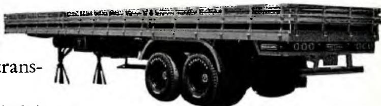
Carga Seca - Semi-reboque 2 eixos
