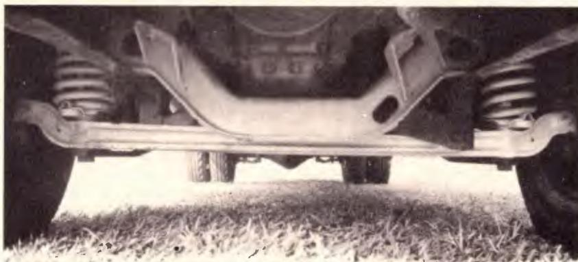
A suspensão dianteira independente impede a transmissão de vibrações à cabina.
