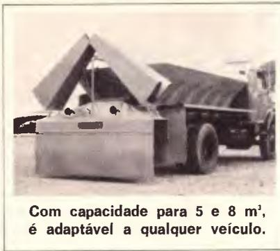
Com capacidade para 5 e 8 m<sup>3</sup>, é adaptável a qualquer veículo.
