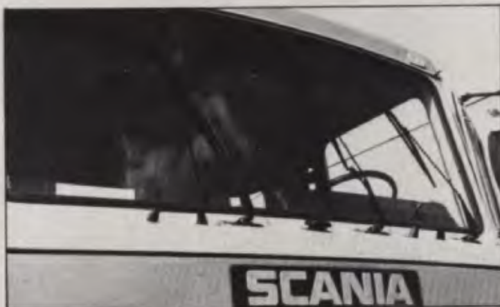
Três limpadores garantem a visibilidade
