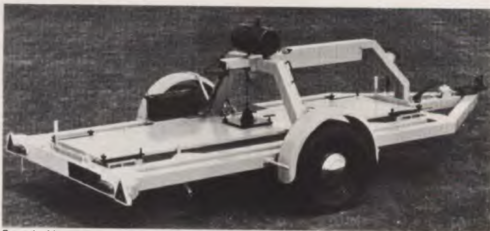
Constituída de duas unidades básicas, a balança é transportável por trailer.
