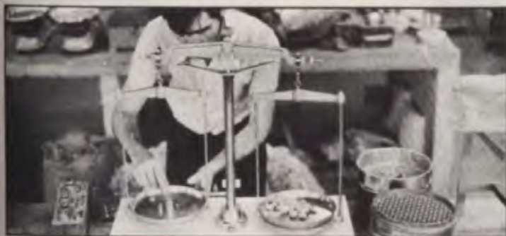
A balança deve ficar sobre uma bancada nivelada, sem vibração.
