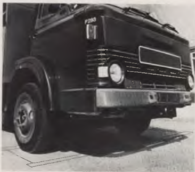
O dispositivo de pesagem "sente" o peso de cada eixo.
