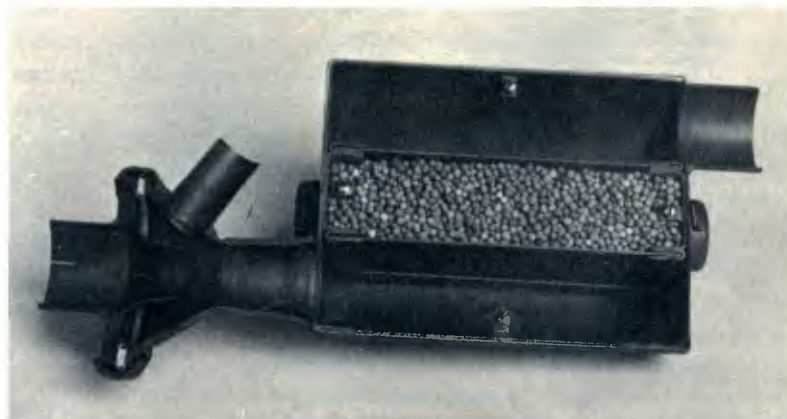
Adaptado ao escapamento da empilhadeira e equipado com uma carga de platina, o oxi-catalisador oxida o monóxido e os hidrocarbonetos residuais da combustão do motor, reduzindo em até 90% os gases perigosos para a saúde.
