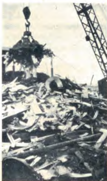
No depósito, um guindaste com eletroímã descarrega o veículo.
