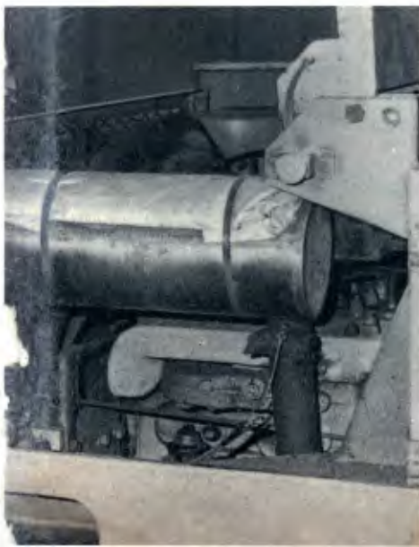
Adaptado ao escapamento da empilhadeira e equipado com uma carga de platina, o oxi-catalisador oxida o monóxido e os hidrocarbonetos residuais da combustão do motor, reduzindo em até 90% os gases perigosos para a saúde.
