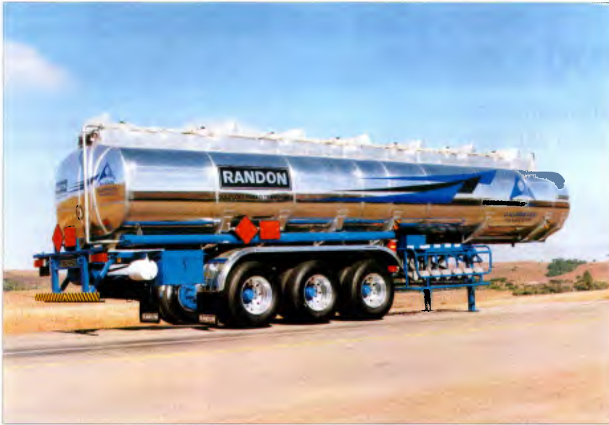
Tanque de alumínio, dividido em sete compartimentos, para 35 mil l
