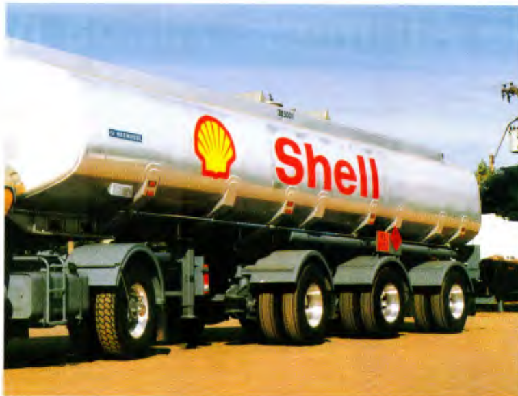
Tanque da Recrusul: eixos espaçados e menor tara
