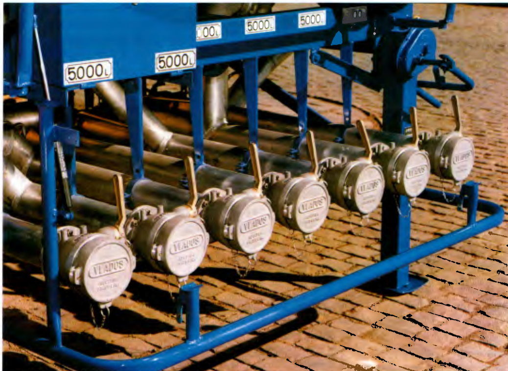
Bottom loading reduz pela metade o tempo para carga e descarga
