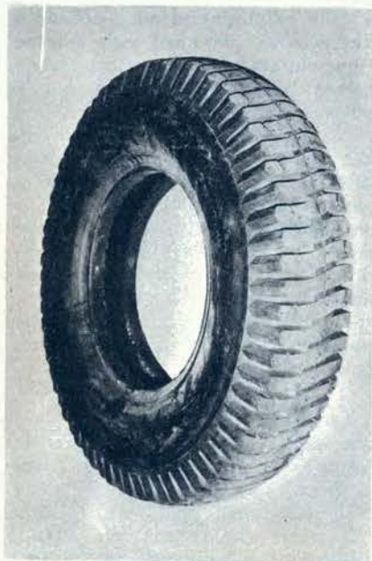
TOPA-TUDO Goodrich. Lameiro: desenho de travas altas que atravessam a banda de lado a lado. Nervuras sobre os gomos. Para estrada sem asfalto. Preço (válido para todos os borrachudos): 9.00 x 20, Cr$ 50.705,00; 10.00 x 20, Cr$ 62.746,00; 11.00 x 20, Cr$... 73.656,00 e 11.00 x 22, Cr$ 77.902,00. Para informações marque o n.º 67 do Serviço de Consulta, na página 65.
