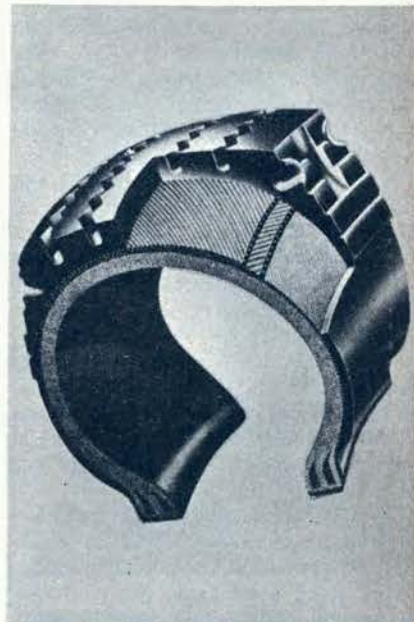
O LADO ÍNTIMO Um corte de carcassa de pneu mostrando suas três partes indispensáveis. Em baixo, os talões (fios de aço cobertos de borracha) que sustentam a carcassa. Depois, as lonas (de um composto de nylon, raion e borracha) e por cima, a banda de rodagem mostrando a formação de seu desenho. Feita de borracha e destinada ao contacto com o solo.
