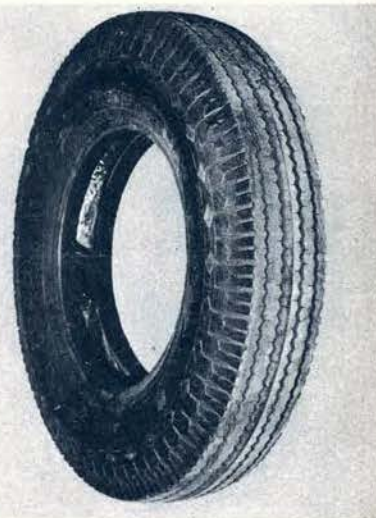
PAPALÉGUAS Goodyear. Quatro raias fundas no sentido da curvatura do pneu. Taquinhos transversais rasos. Objetivo: aderência, estabilidade, marcha suave. Serviço: pesado, no asfalto ou nas rodas dianteiras, em qualquer caso. Preços e capacidade de carga iguais aos dos outros simples. Para informações marque o n.º 65 do Serviço de Consulta, na página 65.
