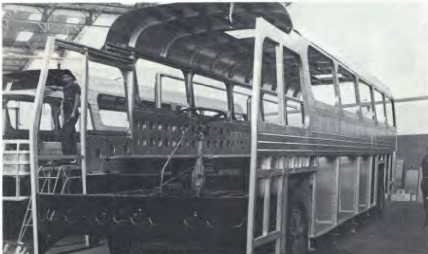
As chapas estruturais contribuíram na concepção do veículo 700kg mais leve
