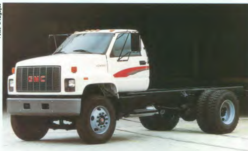
O médio 16-220, com motor de 218 cv e capacidade para 16 toneladas
