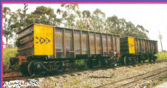
A MRS está adquirindo 270 vagões-gôndola. Cada unidade transporta 100 t de minério de ferro
