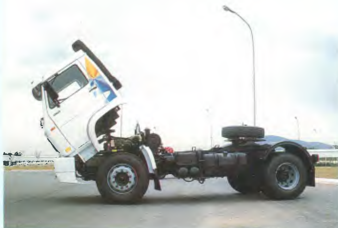
O cavalo mecânico 40.300 é equipado com nova caixa de câmbio e eixo traseiro mais robusto
