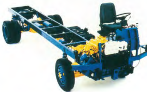
O MA 8.5T com motor MWM adaptado às normas Euro II e caixa de câmbio Eaton é uma das atrações da Fenatran
