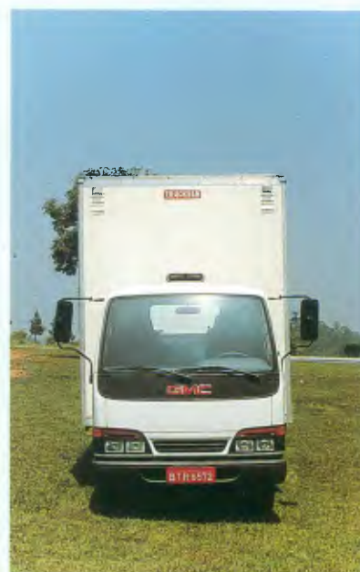
O médio 16-220, com motor de 218 cv e capacidade para 16 toneladas
