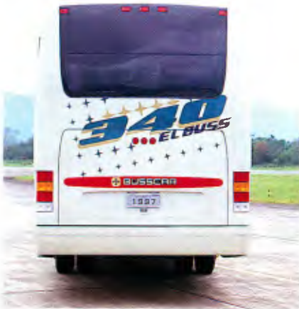
El Buss 340: a traseira foi contemplada com várias inovações, entre elas um conjunto harmonioso com brake-light, porta-placas e refletivo integrados na tampa traseira
