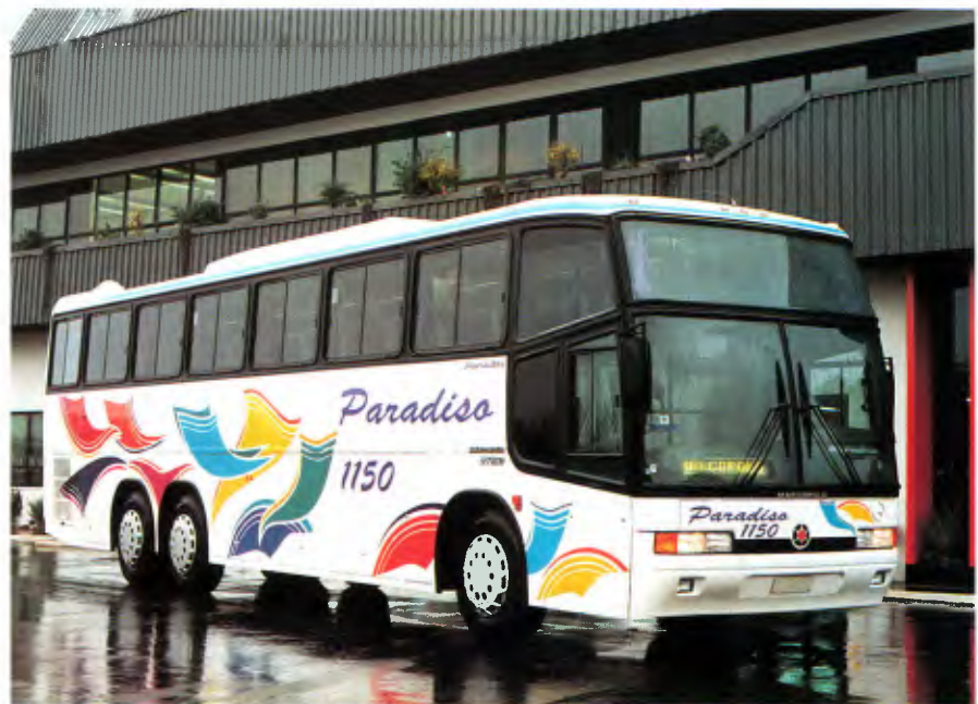
Paradiso GV 1150: sobre plataforma O400 RSD de três eixos, tem aplicação rodoviária e é dotada de poltronas executivas com destaque para o assento móvel
