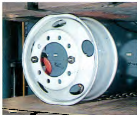
Roda disco de aço soldada resiste uma carga de 13.6 t quando ocorre a deformação de 5 cm.
