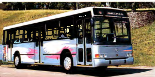
Torino GV: sobre plataforma O371 UL, com entre-eixos de 6,33 m, a carroceria, de três portas para aplicação urbana, tem banco de polipropileno com assento e encosto estofados
