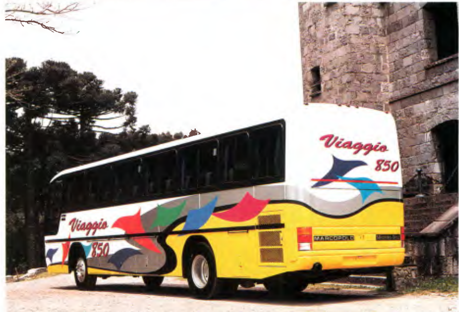
Viaggio GV 850: carroceria indicada para operação de fretamento, tem plataforma O371 UL, entre-eixos de 6,12 m e 49 lugares com poltronas executivas
