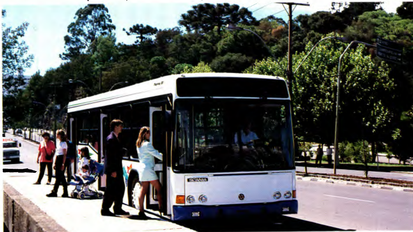
Chassi L113CL com carroceria Marcopolo Torino GV: altura mínima do piso é de 35 cm do solo graças ao sistema pneumático na dianteira
