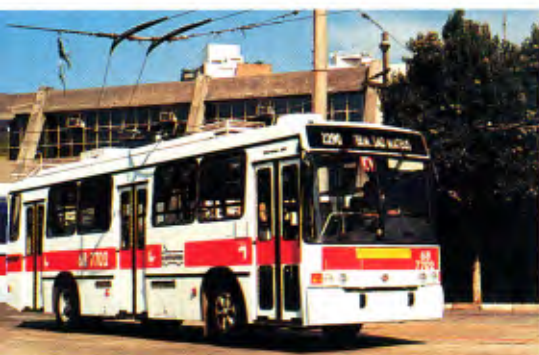
Torino GV Trolebus: a linha extensa de produtos da Marcopolo inclui muitas aplicações, entre elas a carroceria para o ônibus elétrico
