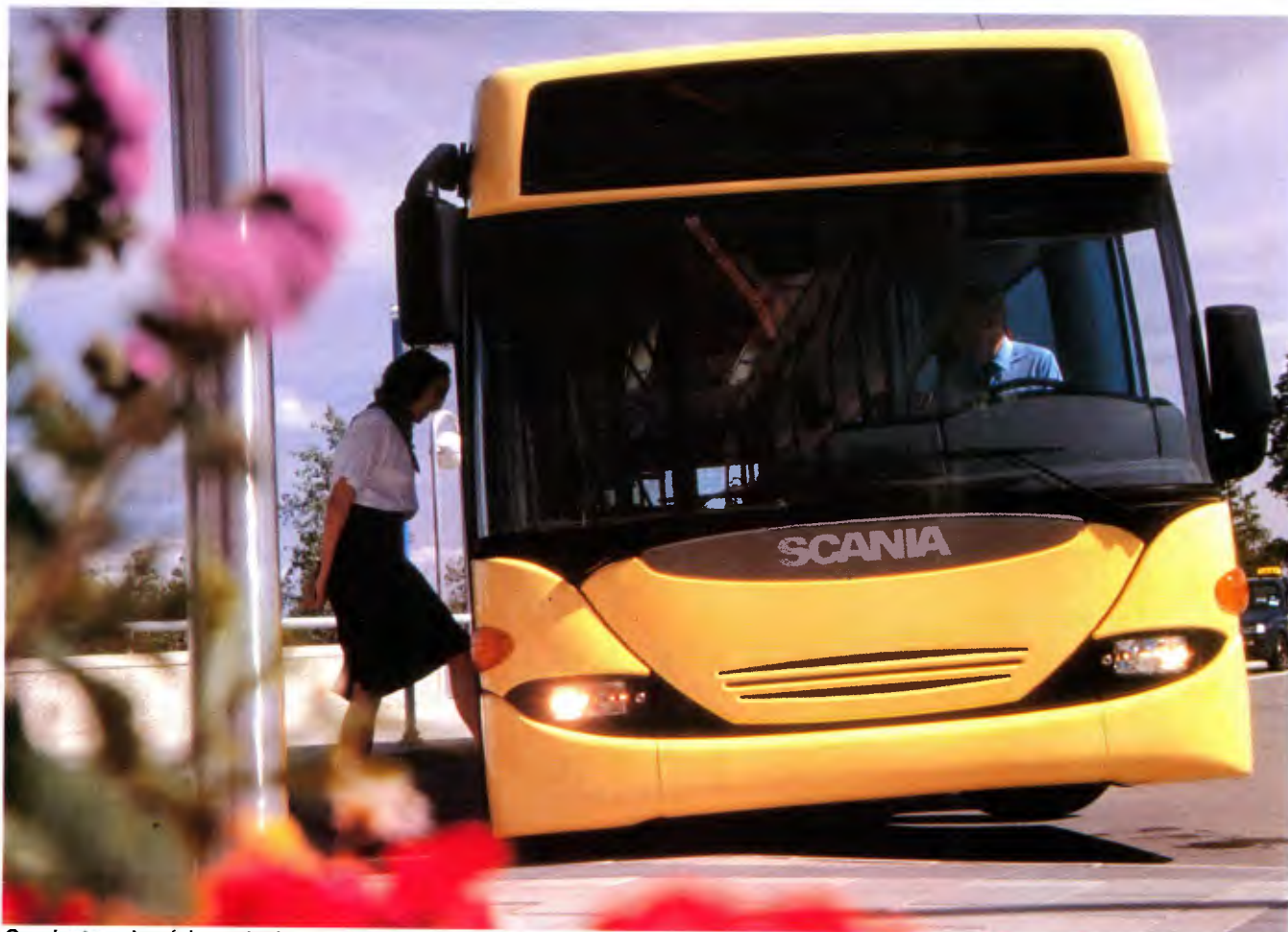
Omnicyt: alumínio reduziu em 600 kg o peso e permitiu um design moderno e empolgante
