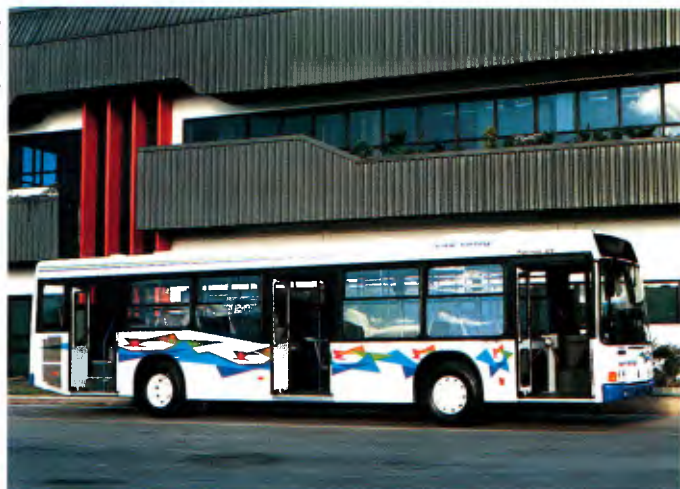
Torino GV Low Entry: sobre chassi piso baixo Scania 113 CLL, tem 12 m de comprimento e três portas de 1,25 m de largura cada; no interior, pega-mãos e corrimãos encapsulados
