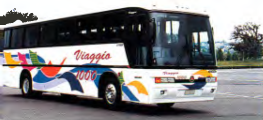
Viaggio GV 1000: sobre chassi Scania F113, motor dianteiro, 12,6 m de comprimento, entre-eixos de 6,68 m e capacidade para 46 passageiros acomodados em poltronas executivas
