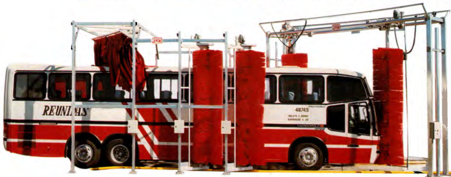
Lavadora completa modelo Plutão: 6 escovas verticais e lava-tetos de cortinas
