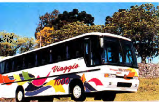
Viaggio GV 1000: carroceria para aplicação rodoviária, também sobre motor dianteiro, com 12 m de comprimento, entre-eixos de 5,94 m e 46/48 lugares
