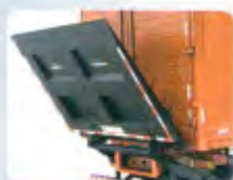
PLATAFORMA ELEVATÓRIA PARA CARGA E DESCARGA
