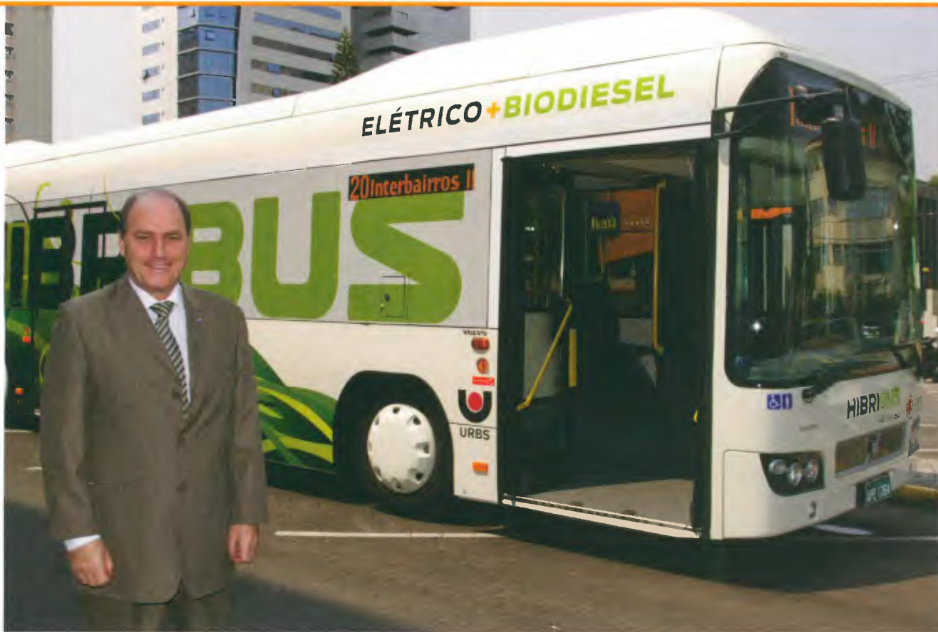
Luis Carlos Pimenta: tecnologia híbrida da Volvo permite economia de diesel de 35% e redução das emissões de gases entre 80% e 90%
