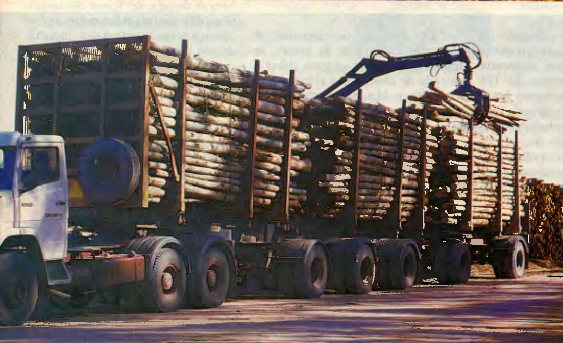
A versão cavalo-mecânico do extra-pesado LS 2635 6x4, com dois semi-reboques de dois e três eixos está sendo testada no transporte de madeira
