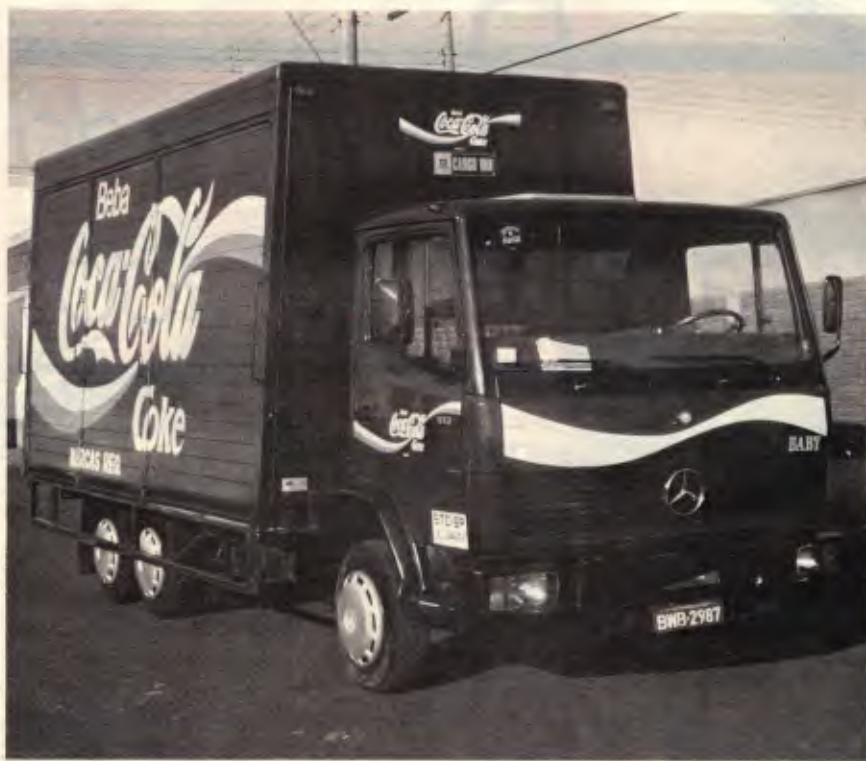
Com cabina do médio e trem-de-força do leve, o 1014 oferece maior capacidade de carga
