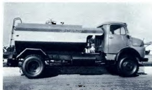
Carro-tanque: para abastecer veículos em obras.
