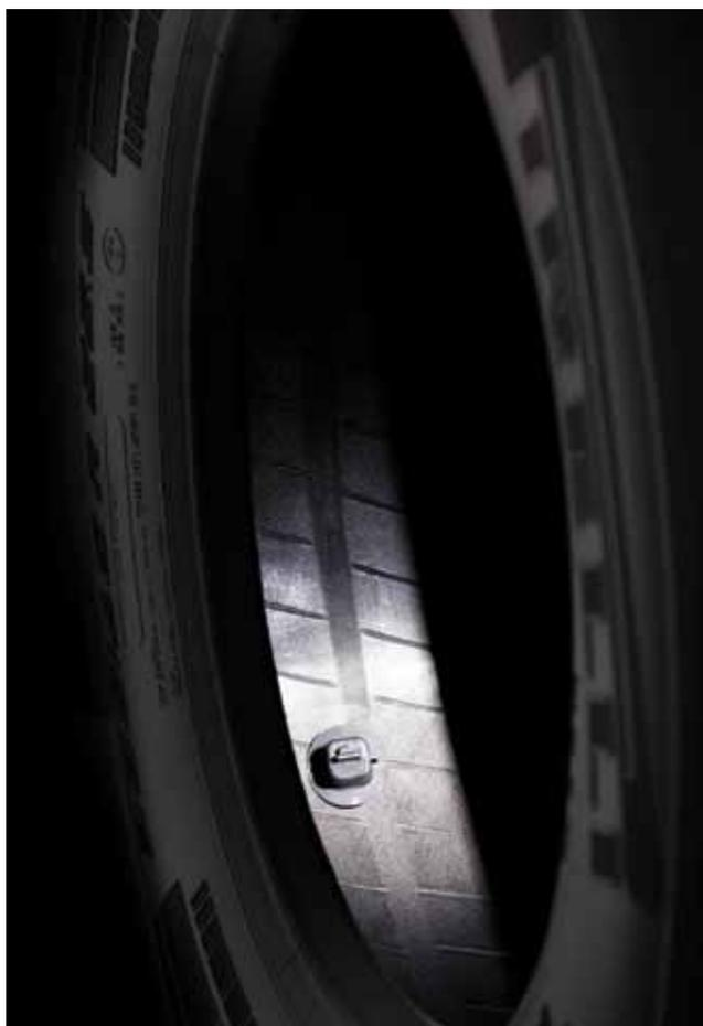
**O sensor é montado na superfície interna do pneu**
