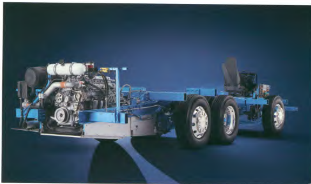
No chassis rodoviário o sistema EBS distribui a frenagem por igual em todas as rodas
