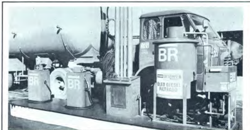
O Dieselimplo puxa o óleo do posto e o filtra sob pressão, retendo as impurezas.
