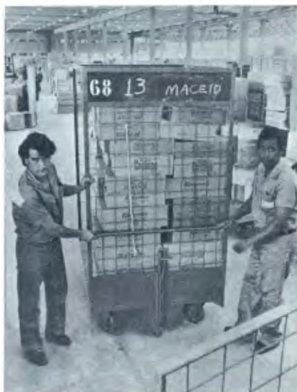
Depois de conferida, a carga é colocada no carrinho. Os operários a empurram até os trilhos. O carrinho fica girando, até que o setor de destino o apanhe, conduza para dentro do caminhão e o descarregue.
