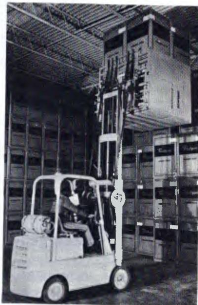
A fotografia acima mostra uma Garra Hidráulica p/ manusear caixas de papelão sem o uso de pallets. É apenas um dos vários tipos de acessórios fabricados pela CASCADE.
