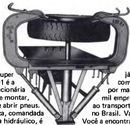
A Ebert Super 1001/0001 é a mais revolucionária máquina de montar, desmontar e abrir pneus. Automática, comandada por sistema hidráulico, é robusta, fácil de operar e não dá problemas de mecânica. Sua qualidade e eficiência
