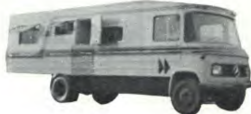
A solução para seu lazer está nas Motor-casas Guarani. Estrutura em perfis de duralumínio e chapas de alumínio, com janelas corrediças e basculantes. O conforto de sua casa sobre rodas.
