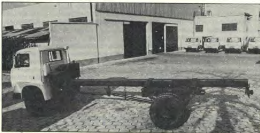
Em vez de duas longarinas, o protótipo possui apenas uma monoviga central
