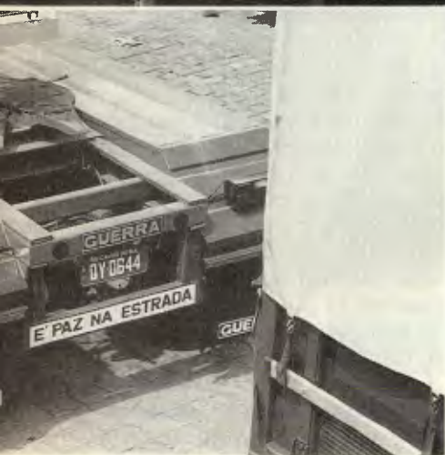
Rodotrens (semi-reboques duplos): o protótipo da Randon ainda não tem licença especial; o da Guerra, tem uma segunda quinta roda
