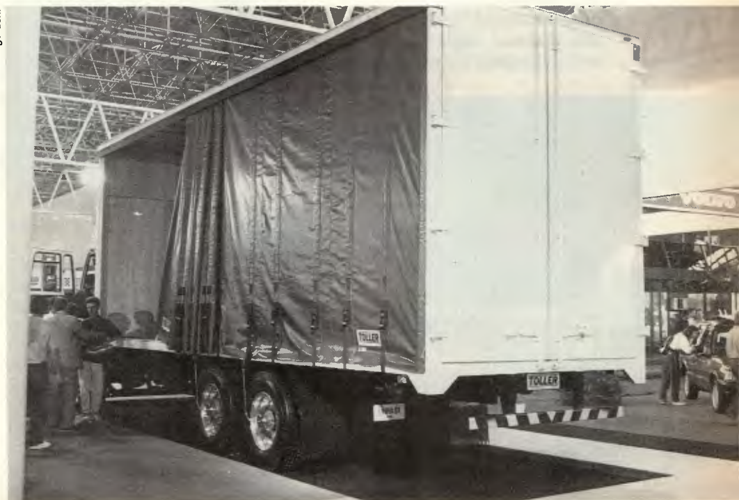
O baú Sider tem estrutura em aço-carbono e laterais em lona reforçada, da Alpargatas
