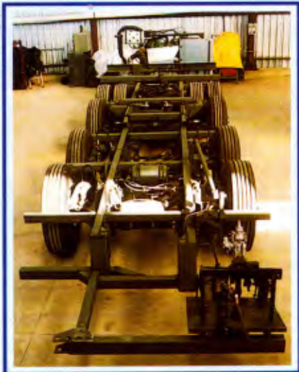
Volvo B12: primeiro chassi Volvo com segundo eixo dirigível
