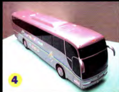
4 A maquete do modelo de ônibus pronta, usada para ajustes no projeto
