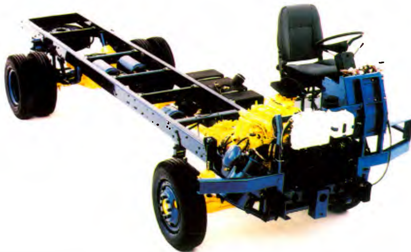
O chassi MA 8.5T, da Agrale, com motor MWM 4.10 TCA, turbo aftercooler: 140 cv de potência, 43 mkgf de torque e respeito à norma ambiental Conama IV
