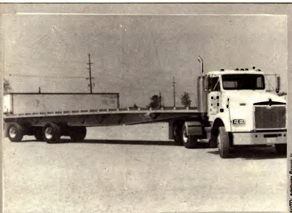
Carreta de alumínio construída pela Schilli leva 4 000 kg de carga a mais
