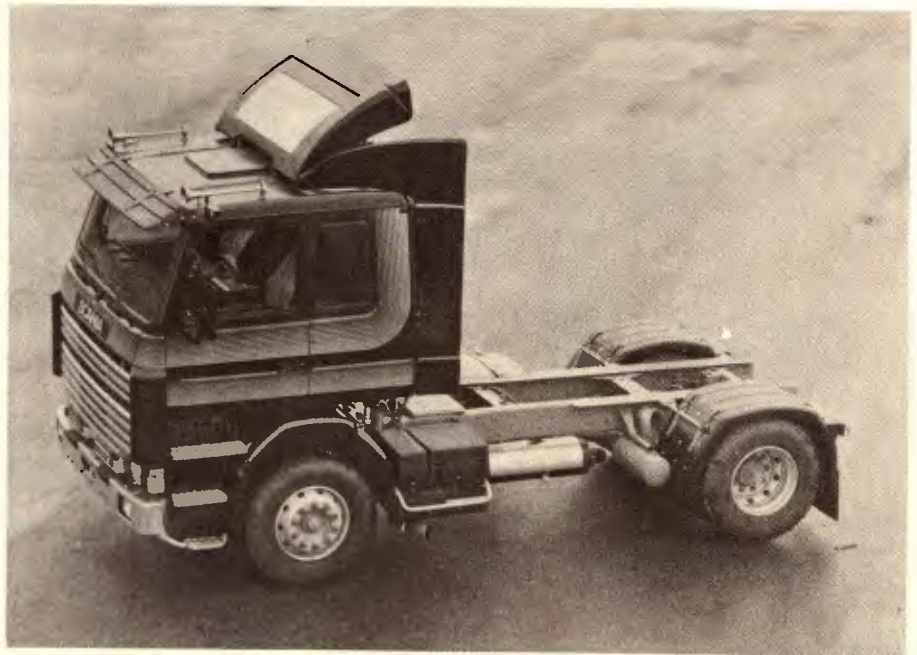
Defletor diminui a resistência do ar e elimina a influência do vento lateral
