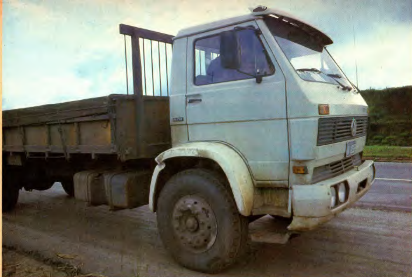
O 16-170, com motor Cummins de aspiração natural, a terceira versão do semipesado da Volkswagen
