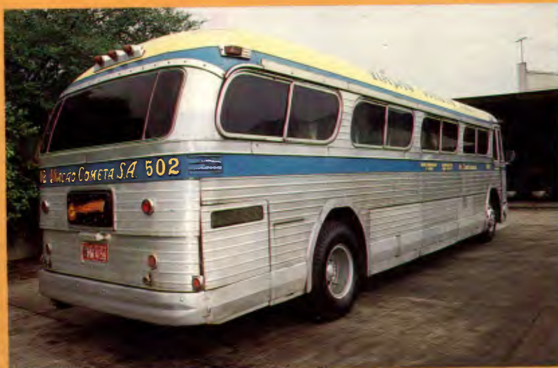
O notável Morubixaba foi o primeiro ônibus equipado com janelas inclinadas, vidros ray-ban, ar-condicionado e calefação.
