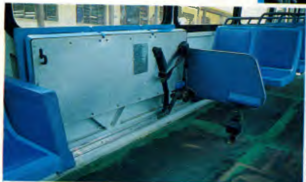
O Apollo T-40 transporta 46 passageiros sentados ou 43, quando reserva lugar para cadeira de rodas. Os bancos, sem apoio para os pés, facilitam a limpeza do piso
