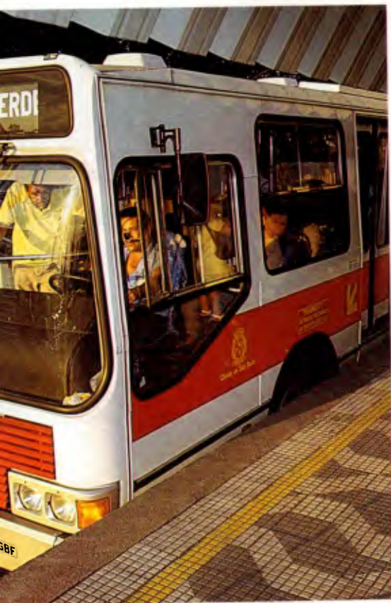
Corredor paulistano utiliza ônibus de cinco portas para possibilitar o embarque e desembarque de passageiros de ambos os lados do coletivo
