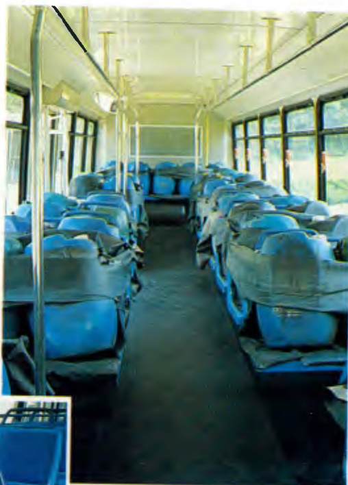
O Apollo T-40 transporta 46 passageiros sentados ou 43, quando reserva lugar para cadeira de rodas. Os bancos, sem apoio para os pés, facilitam a limpeza do piso
