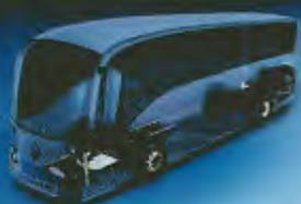
Chassi buggy equipado com sistema flexível de alongamento, que possibilita instalação de carrocerias de bagageiro passante com comprimento de 12 a 13,20 m.
