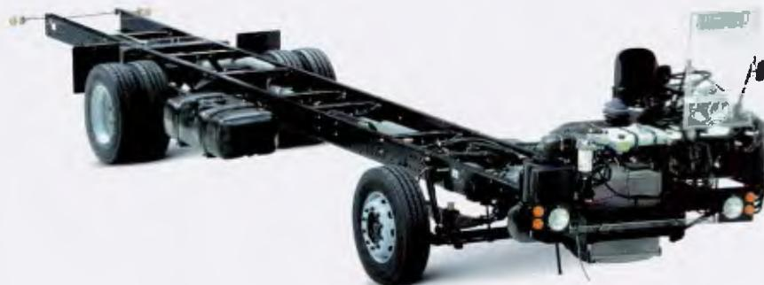
Chassi OF 1722, com motor de 4 cilindros, para 17 toneladas de pbt
