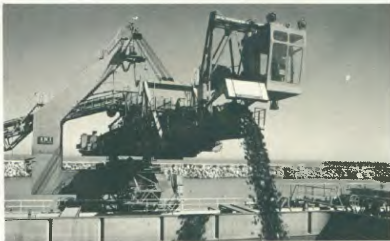
"Ship loader": movimenta-se sôbre trilhos e carrega navios a 6 000 t/n.
