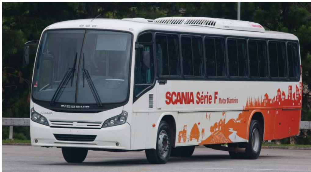
Ônibus urbanos Scania da série F têm motores dianteiros de 250 cv a 310 cv de potência
