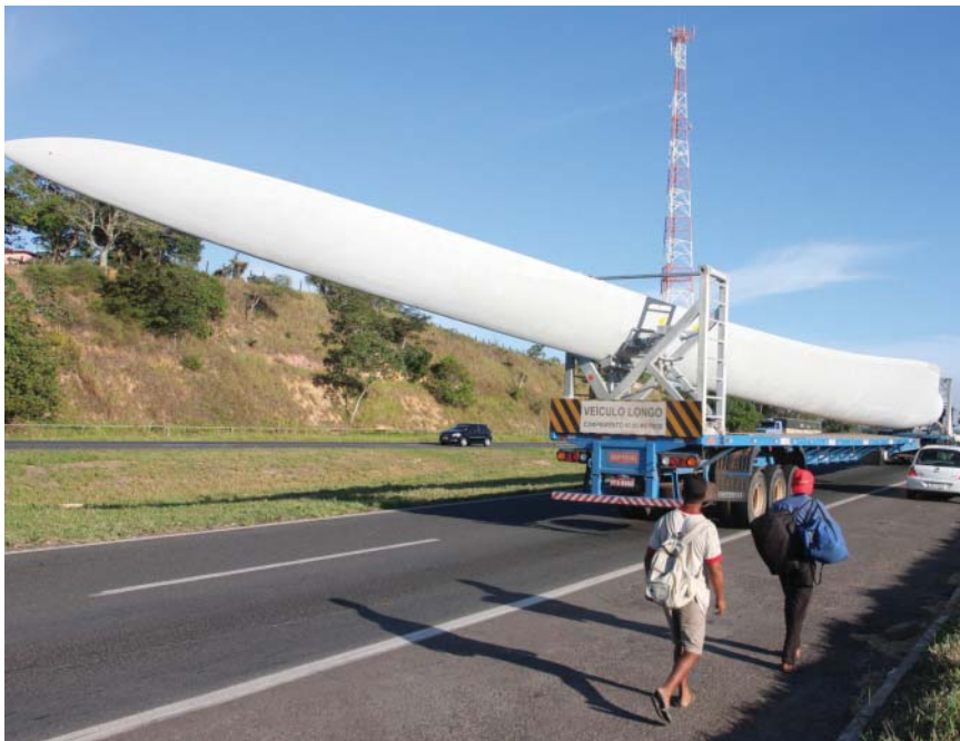
Os implementos são telescópicos, adaptáveis aos tamanhos das peças transportadas
