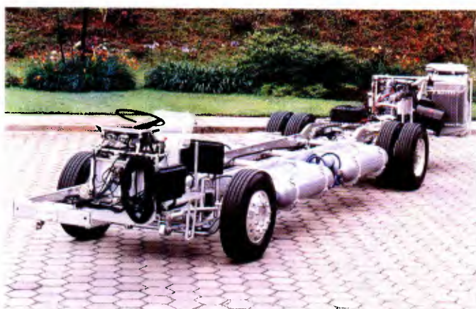
OF-1417: motor OM-904, dispensa bomba injetora convencional OH-1623 LG: motor M 366 LAG, com gerenciamento eletrônico
