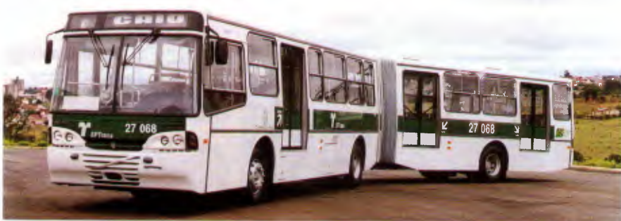
Modelo ALpha articulado com seis portas sobre chassi Volvo B10M
