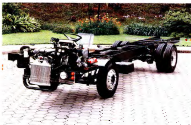
OF-1417: motor OM-904, dispensa bomba injetora convencional OH-1623 LG: motor M 366 LAG, com gerenciamento eletrônico
