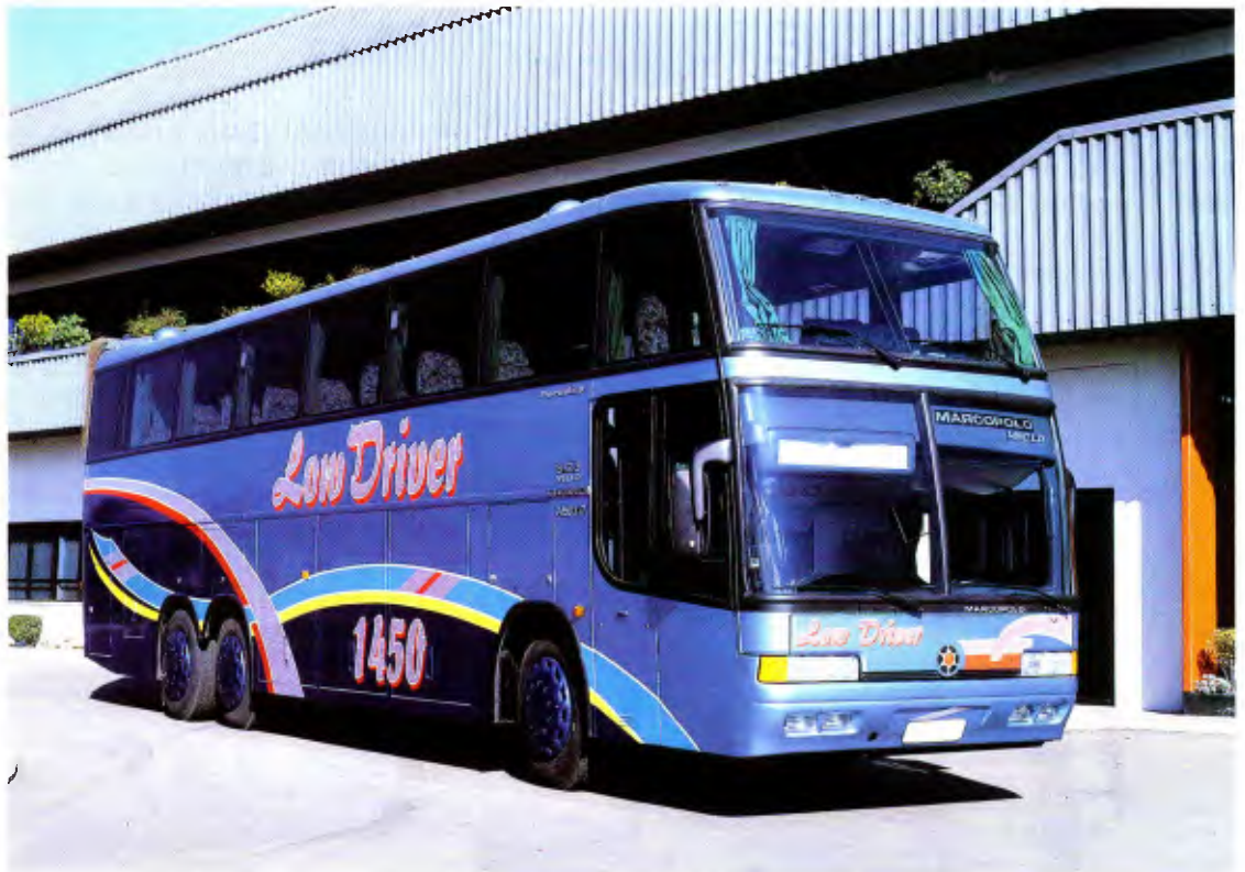
Double decker Paradiso 1450 LD montado sobre chassi Volvo B12 B
