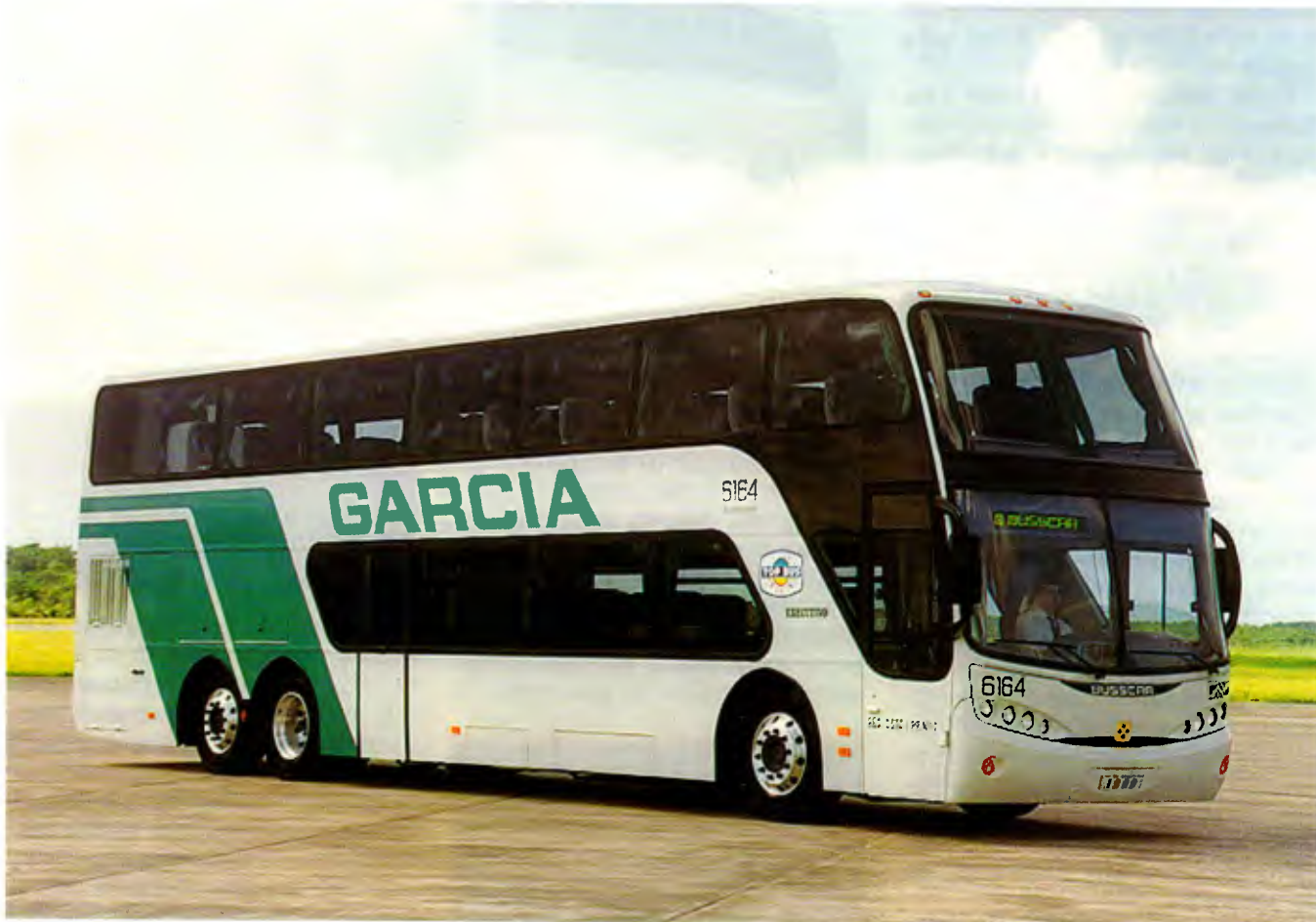
Primeiro Panorâmico DD montado sobre o novo chassi Scania K124 EB
