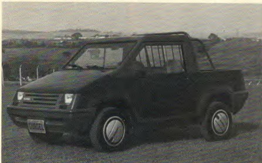
A picape do Cena pesa 600 quilos, carrega 350 e utiliza motor de dois cilindros
