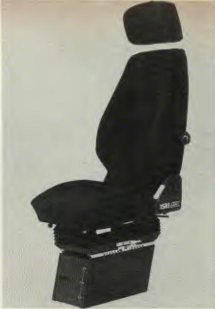
dada por uma válvula de nível e came, pré-ajustados na fábrica. Estes, por sua vez, comandam o enchimento da mola de ar. A regulagem de apoio lombar, manual, permite ajuste do encosto à curvatura exata da coluna vertebral do motorista, atuando na altura correta e na amplitude desejada.
