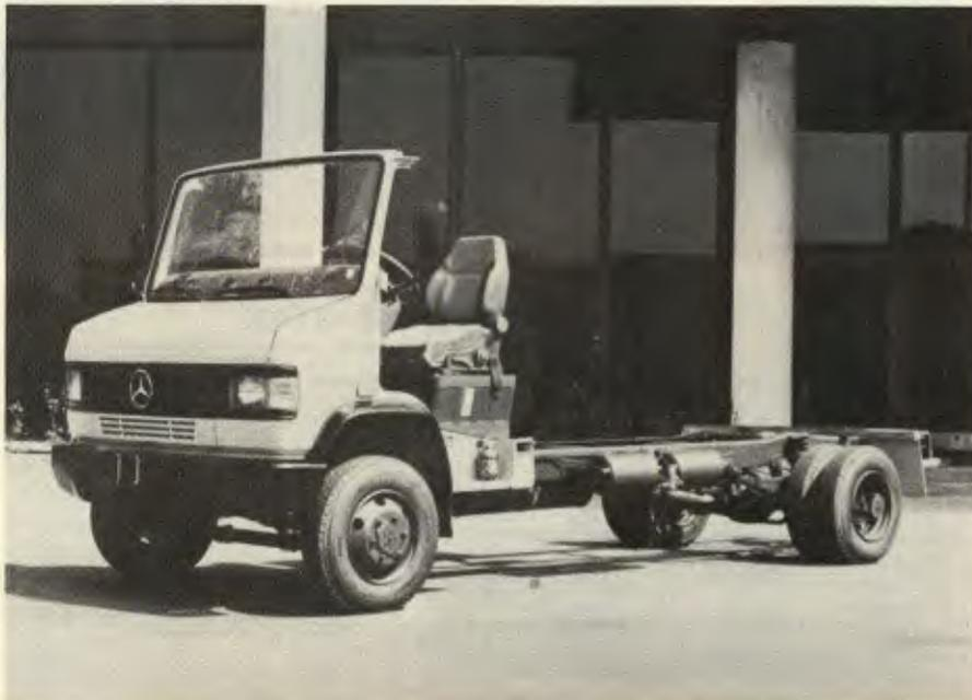
O chassi para microônibus mantém o design da cabina trem de força do caminhão
