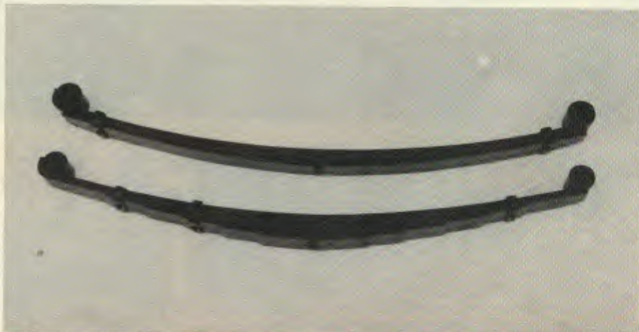
Lâminas com perfil parabólico mantêm tensão constante e controlada
