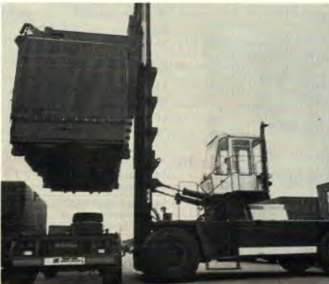
A empilhadeira porta-contêiner faz o carregamento, o cavalo mecânico engata a carreta e não se perde tempo nos terminais de carga, na busca de eficiência cada vez maior
