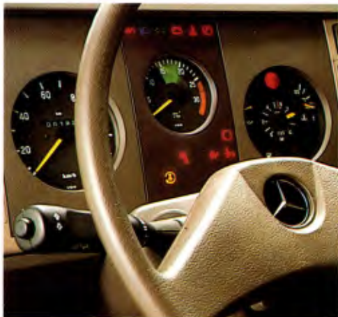
Iluminação translúcida e regulável no painel de instrumentos.
