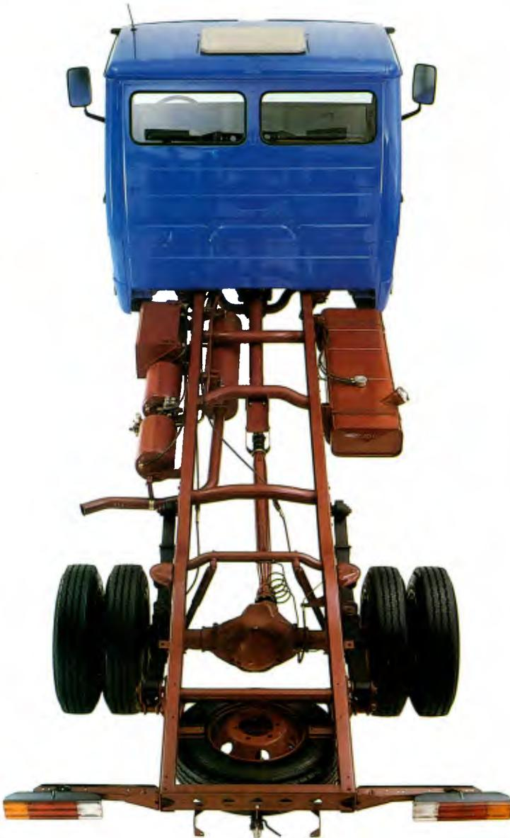
*O chassi dos novos leves Mercedes-Benz foi construído com travessas tubulares. É mais leve, resistente e flexível. A suspensão é composta de feixes de molas semi-elípticas e amortecedores telescópicos.*
