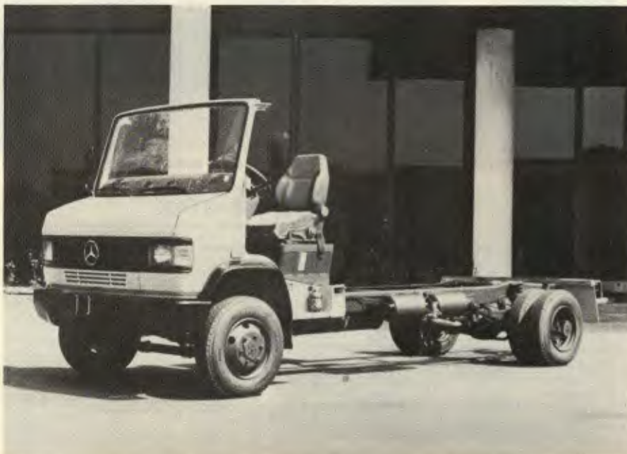
O chassi para microônibus mantém o design da cabina trem de força do caminhão
