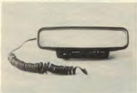
Fabricado pela Metagal, o espelho retrovisor eletrônico foi desenvolvido para evitar ofuscamento por reflexo nos olhos do motorista, em caso de um veículo que estiver atrás ligar os faróis altos.
