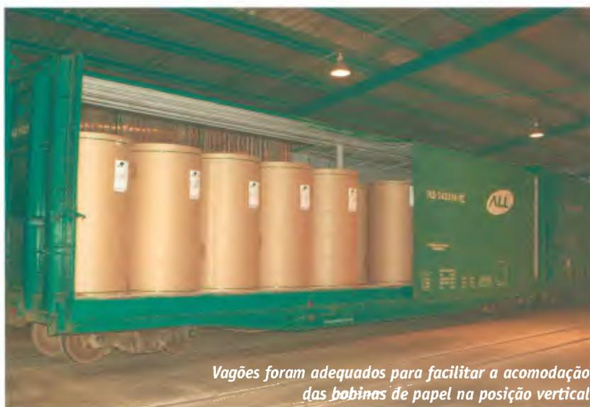
*Vagões foram adequados para facilitar a acomodação das bobinas de papel na posição vertical*
