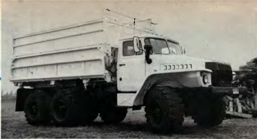
Com caçamba basculante lateral, para ambos os lados, pode entrar no meio do canal
