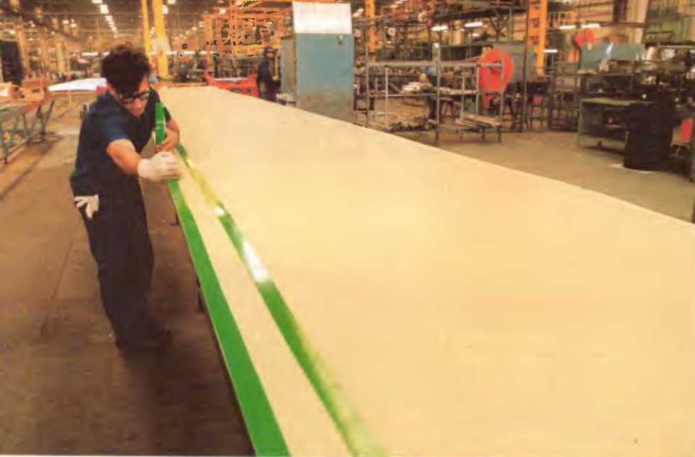
Montagem do teto fora da linha, uma das fases aceleradas na produção do Alpha
