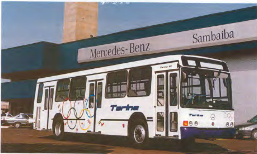
Torino GV sobre plataforma 371UL, 12 m, para 26 passageiros mais cobrador
