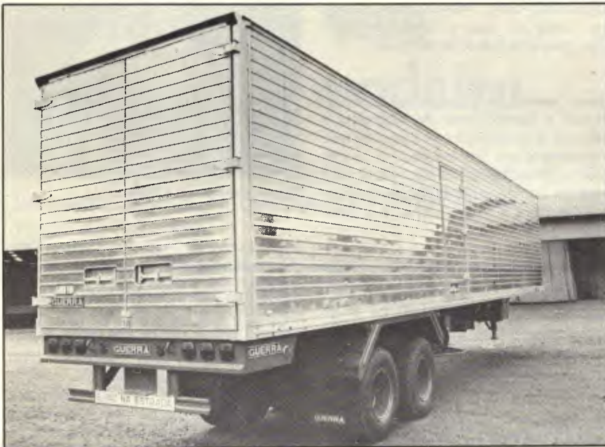
Carroçaria modulada Cargovan montada pela A. Guerra.
