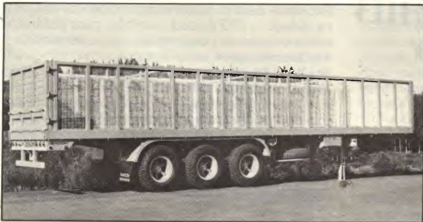
Semi-reboque de carroçaria aberta para granéis da Rodoviária.
