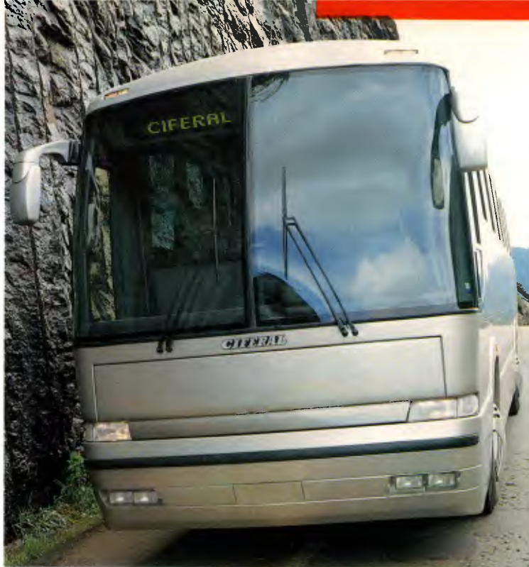
O pára-brisa é fixado por meio de adesivo
