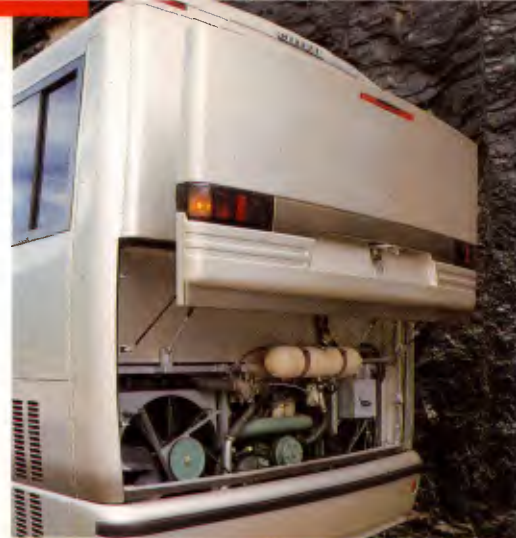
Tampa pantográfica: acesso para manutenção
