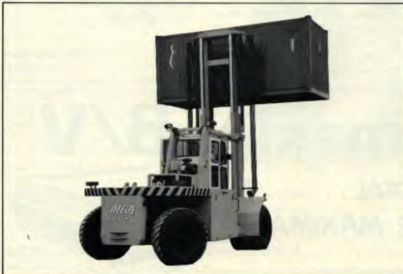
O modelo II-C30D tem motor Scania e está em operação em três portos marítimos
