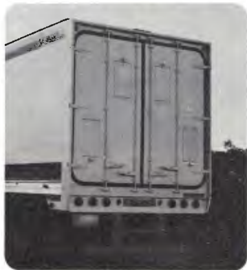
Portas de cantos arredondados, para maior resistência ao conjunto, com abertura total de 270°.
