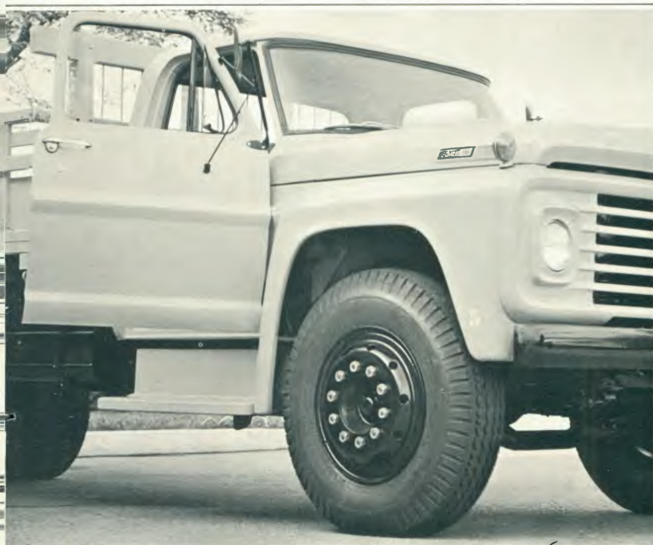
F-750: a arma da Ford na luta pelos semipesados. Com motor Perkins de 152 cv, pode tracionar até 22,5 t.
