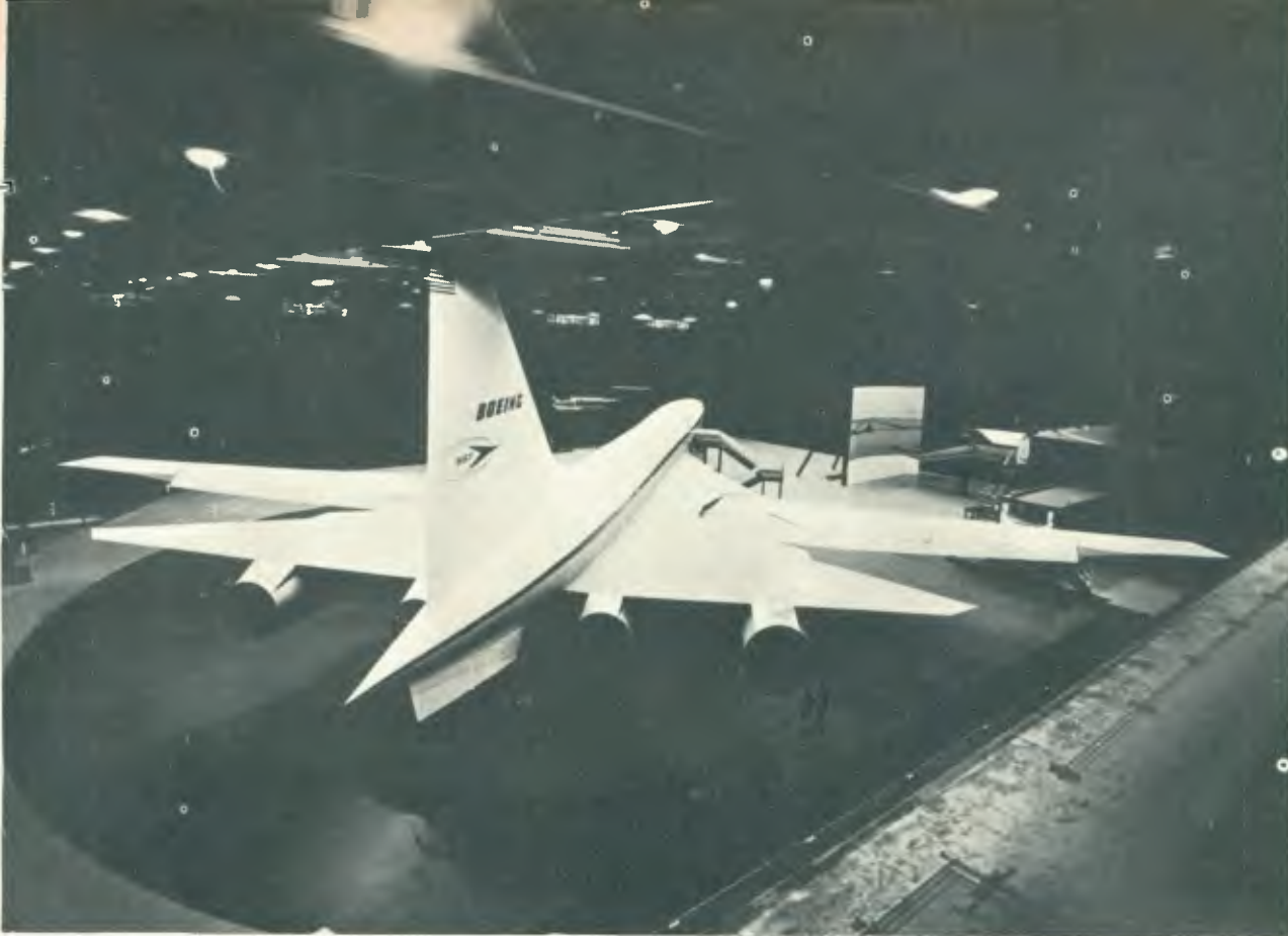
SST: os problemas foram da geometria variável da asa, passando pelo aquecimento, até o "boom" supersônico.
