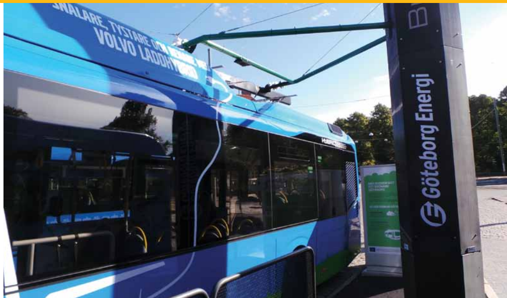
A recarga do híbrido é feita diretamente na rede elétrica e demora de seis a dez minutos
